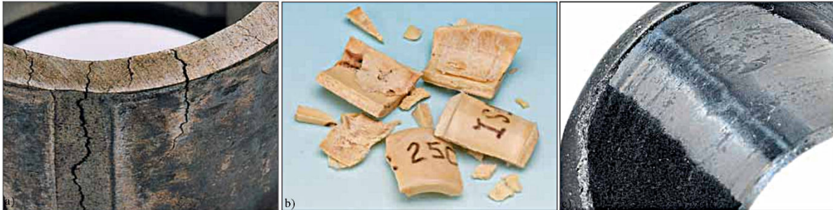
Slika 31. a) Oštećenje sinterirane bronce, b) oštećenje polimera sa staklenim vlaknima, c) oštećenje PA66 [61]
