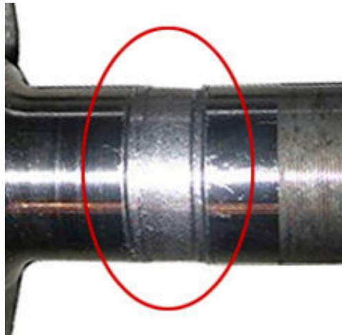
Slika 20. Oštećenje rukavca uslijed pojave zavarivanja trenjem [29]
