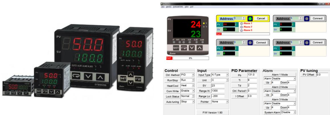
Slika 2.26. Elementi za upravljanje radom grijaca zraka (lijevo) i programsko sučelje za upravljanje grijacem zraka (desno)
