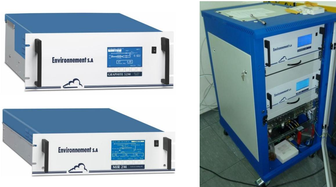
Slika 2.45. Uređaji za mjerjenje emisija HC, CO i CO<sub>2</sub>
