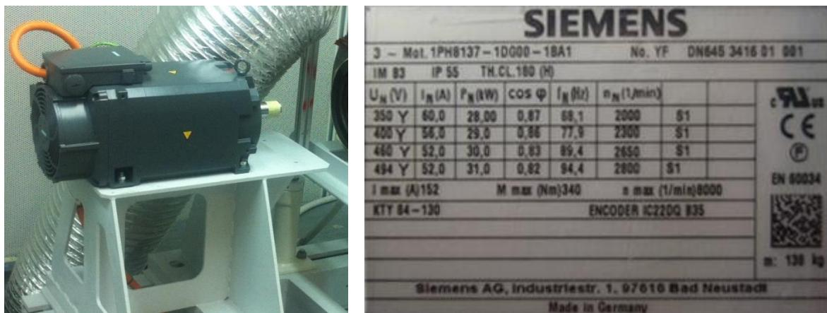
Slika 2.16. Elektromotor Siemens – kočnica
