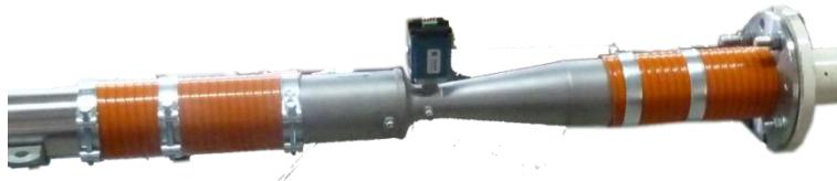
*Slika 2.20. Laminarni mjerač protoka zraka*
