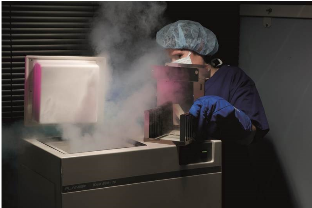
Slika 35. Uređaj za kontrolirano zamrzavanje Planer PLC, UK
