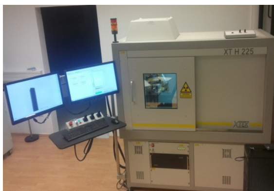
Slika 2-4. Industrijski CT skener Nikon XT H 225.
