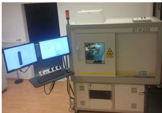
Slika 2-4. Industrijski CT skener Nikon XT H 225.
