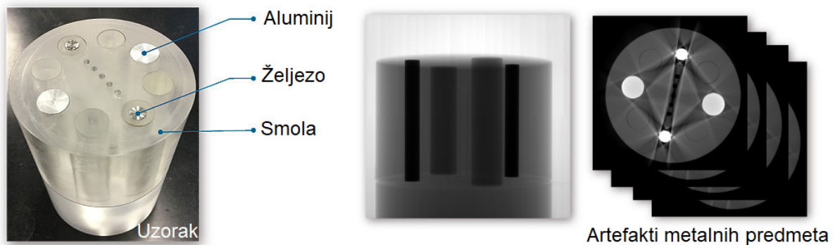
Slika 2-25. Artefakti metalnih predmeta [45].
