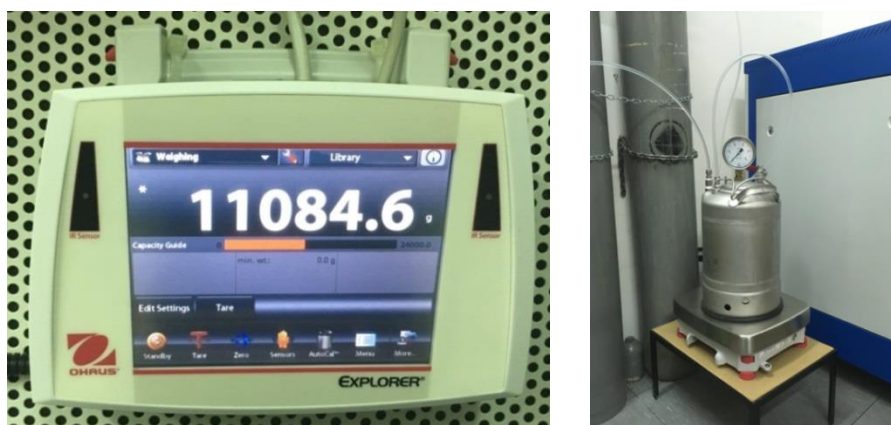
Slika 2.19. Ručno korisničko sučelje vage za mjerenje količine goriva u spremniku (lijevo), vaga i spremnik goriva (desno)
