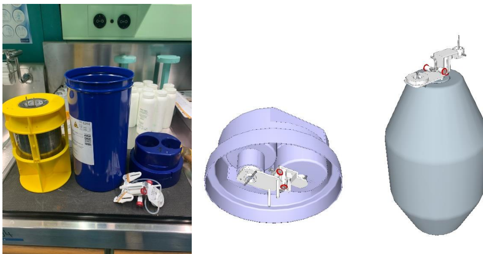
Slika 9. Postupak rastavljanja iskorištenog ^{99}\text{Mo}/^{99\text{m}}\text{Tc} generatora
