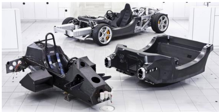
Slika 2. McLarenovi okviri od kompozita s ugljičnim vlaknima [2]
