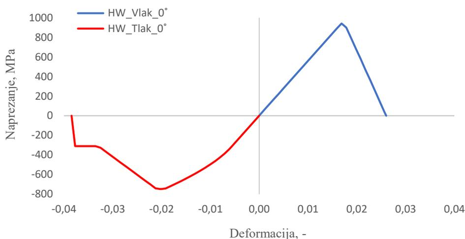
**Slika 16. Dijagram napreznost-deformacija za vlak i tlak**
