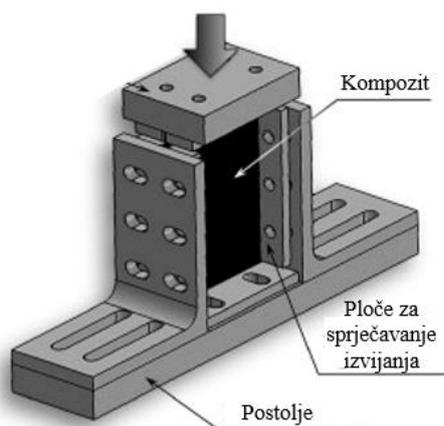
**Slika 8. Oprema za tlačni test nakon udara (CAI) [11]**
