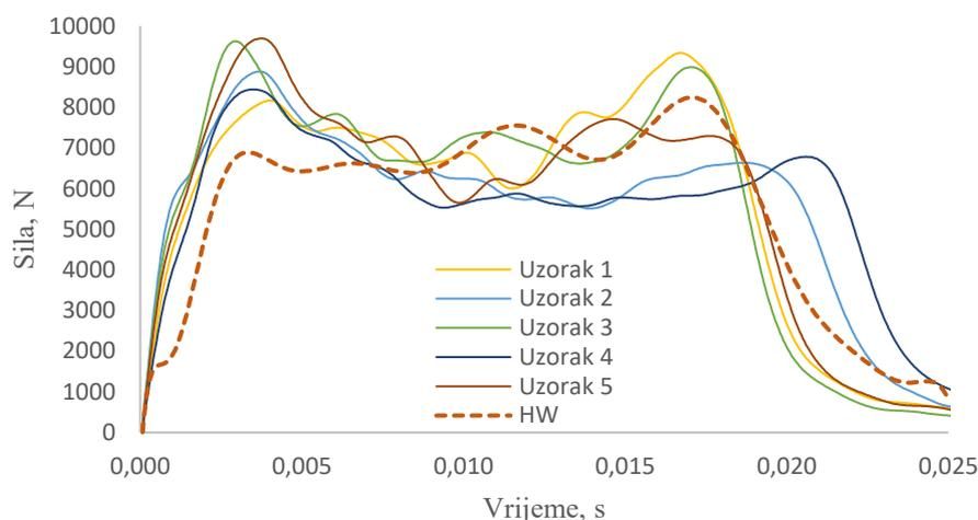
**Slika 40. Krivulje sile udara u apsorber „otvorenog“ profila pri  $v_0 = 7 \text{ ms}^{-1}$**
