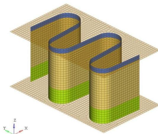
**Slika 35. Sinus uzorak „zatvorenog“ profila**
