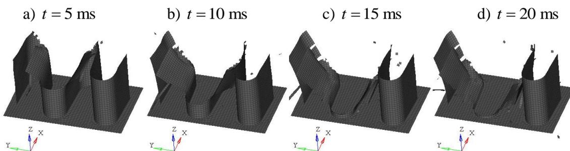
**Slika 50.** Progresija oštećenja apsorbera „otvorenog“ profila pri  $v_0 = 10 \text{ ms}^{-1}$
