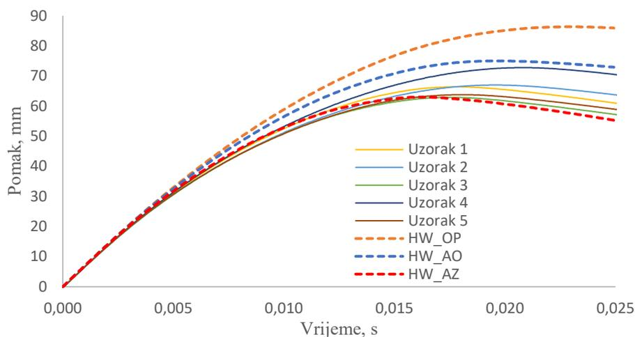
**Slika 29. Krivulje intruzije udarača dobivene eksperimentalnim putem i korištenjem *HyperWorksa***
