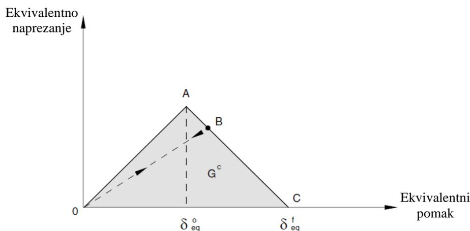
**Slika 19. Dijagram ovisnosti ekvivalentnog naprezanja i ekvivalentnog pomaka [18]**
