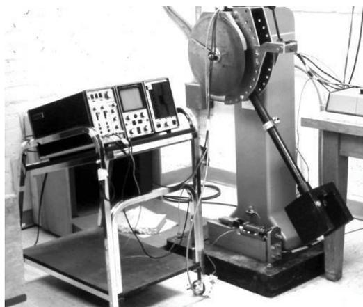
**Slika 7. Aparatura za ispitivanje čistog vlačnog naprezanja [9]**
