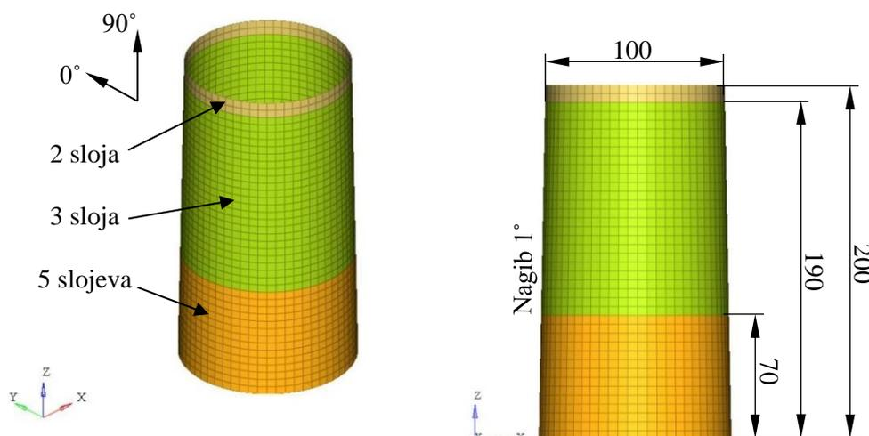
Slika 27. Apsorber „zatvorenog“ profila s dimenzijama u mm
