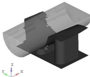
**Slika 58.** Deformirani oblik u trenutku maksimalne intruzije udarača ( $t = 16,2$  ms) u apsorber „zatvorenog“ profila pri  $v_0 = 10$  ms<sup>-1</sup>
