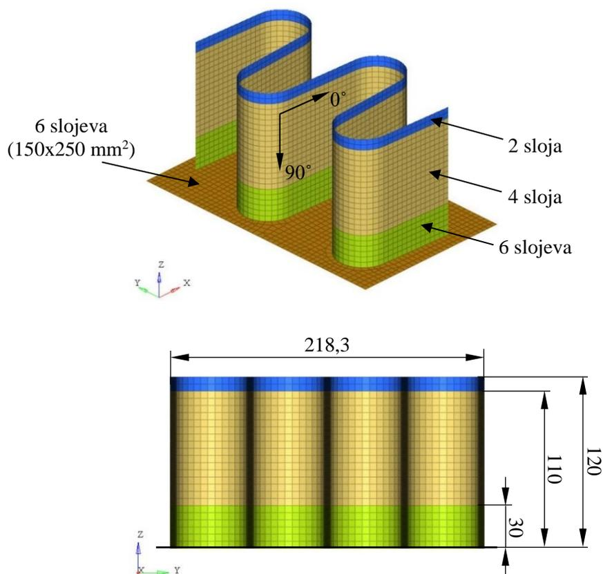
Slika 25. Apsorber „otvorenog“ profila s dimenzijama u mm
