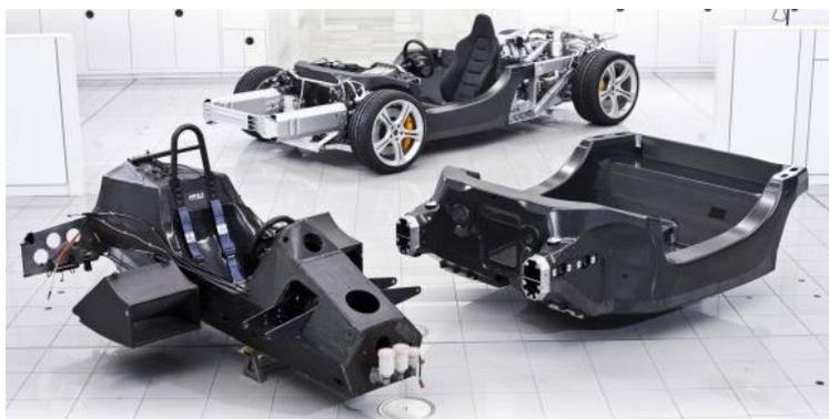
**Slika 2. McLarenovi okviri od kompozita s ugljičnim vlaknima [2]**
