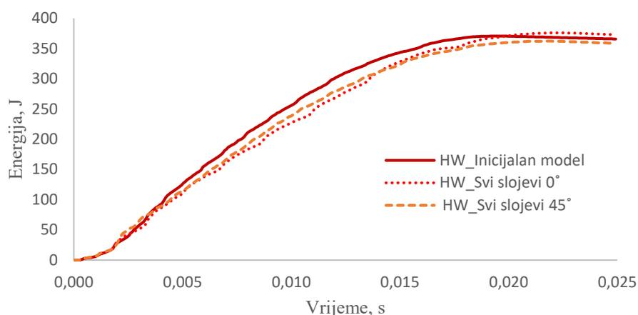
**Slika 62. Ovisnost apsorbirane energije o rasporedu slojeva**
