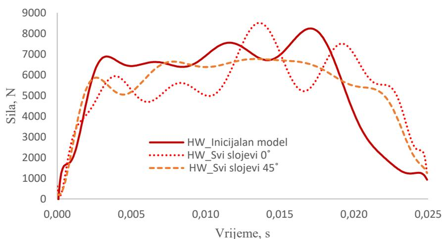
**Slika 61. Ovisnost sile udara o rasporedu slojeva**
