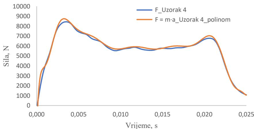
**Slika 39. Usporedba stvarne sile i sile dobivene primjenjujući drugi *Newtonov zakon* na eksperimentalnim podacima**
