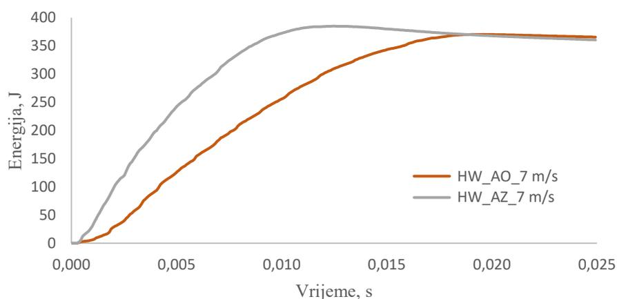
**Slika 59.** Usporedba krivulja unutarnje energije za udar pri  $v_0 = 7$  ms<sup>-1</sup> na apsorber „otvorenog“ i „zatvorenog“ profila
