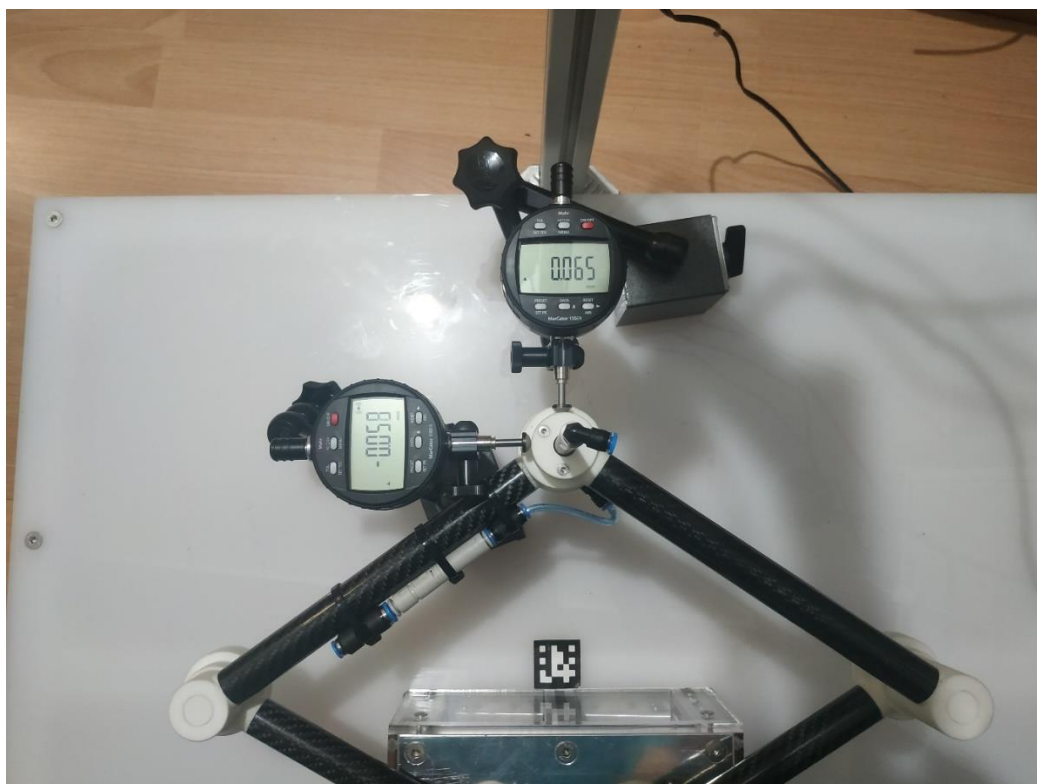
Slika 153. Mjerenje ponovljivosti, pozicija 3
