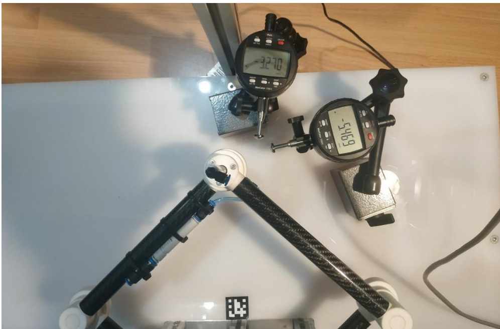
Slika 150. Mjerenje ponovljivosti, pozicija 1, robot odmaknut
