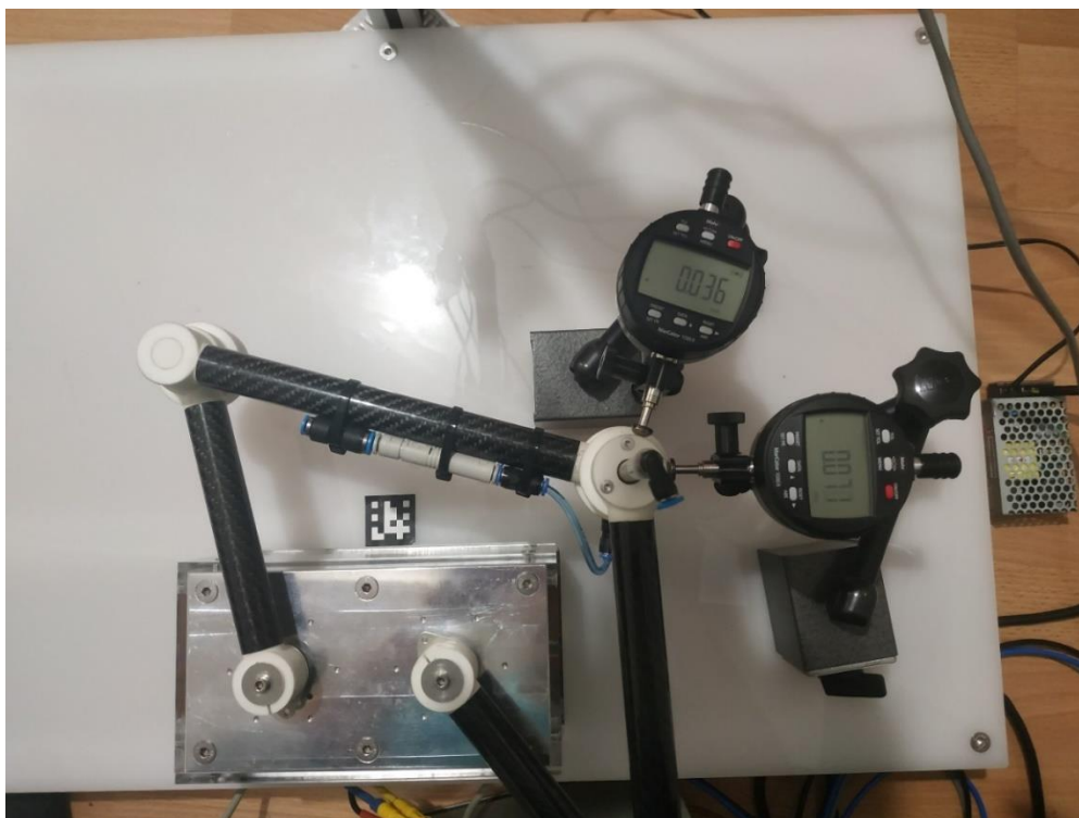
Slika 154. Mjerenje ponovljivosti, pozicija 4
