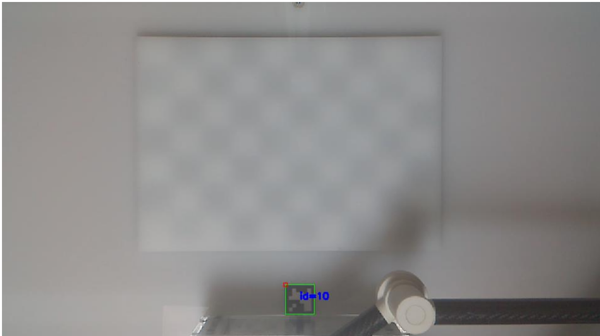
Slika 134. Kalibracija koordinatnog sustava, detekcija markera
