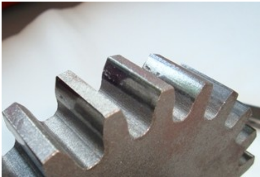
Slika 4.2.4.8. Površina zuba NL 380K zupčanika nakon ispitivanja
