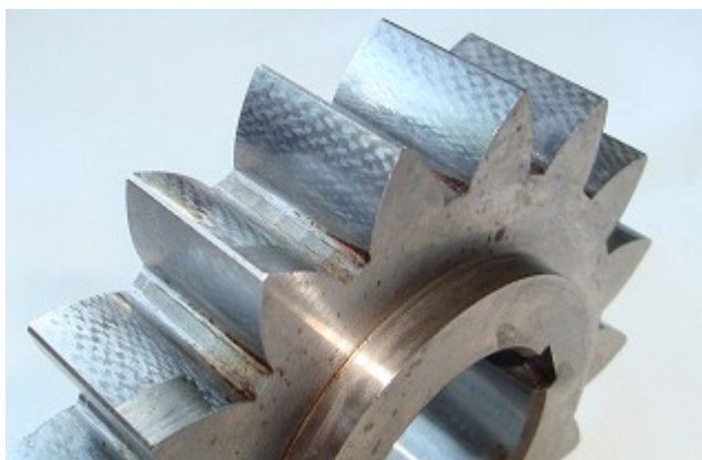
Slika 3.3. Površina boka obrađena Maagovim križnim brušenjem
