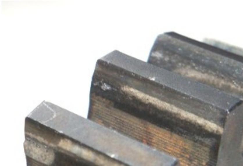
Slika 4.2.4.4. Površina zuba NL 380 zupčanika nakon ispitivanja
