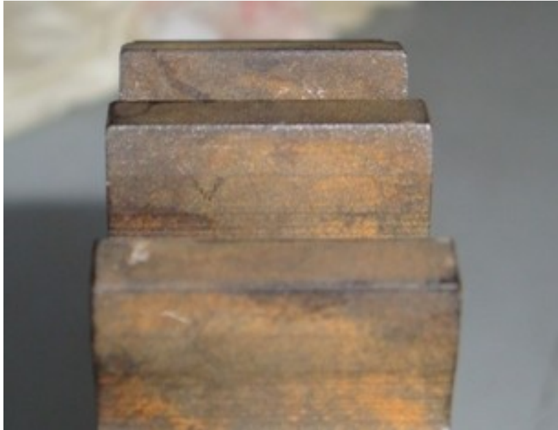
Slika 4.2.4.3. Površina zuba NL 380 zupčanika prije ispitivanja
