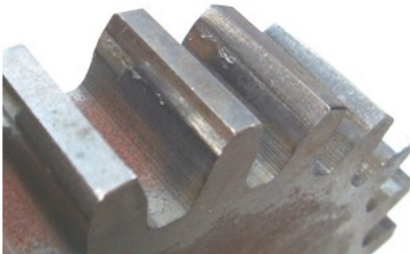
Slika 4.2.4.6 Površina zuba NL 240 zupčanika nakon ispitivanja
