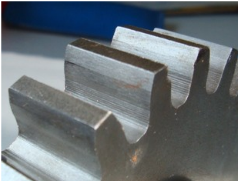
Slika 4.2.4.1 Površina zuba NL zupčanika prije ispitivanja
