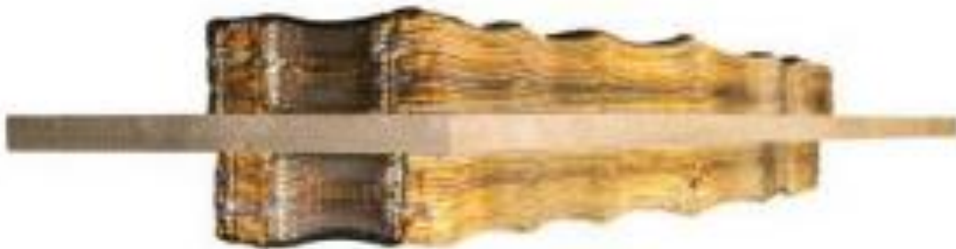
Slika 11. Back to back način WAAM postupka [6]
