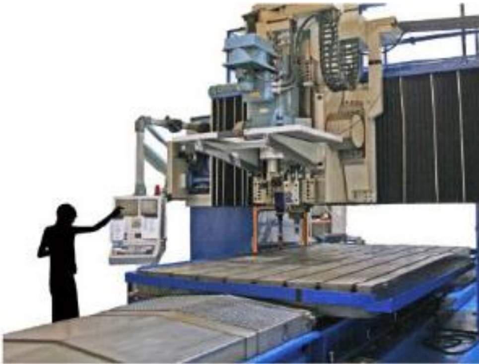
Slika 9. Primjer stroja za izvedbu WAAM postupka (naglasak na veličini) [6]
