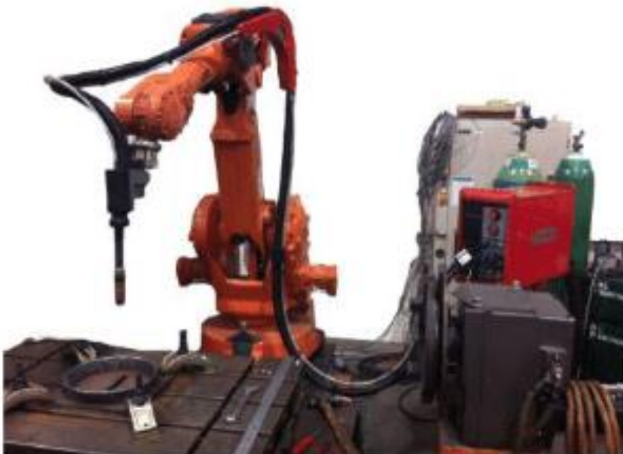
Slika 8. Robot za zavarivanje sa šest osi gibanja [6]
