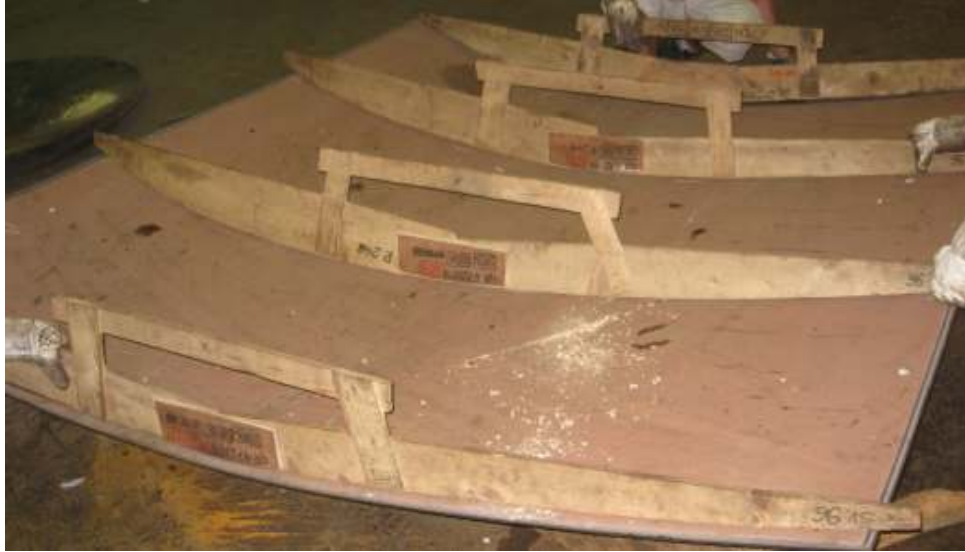
Slika 14. Kontrola zakrivljenosti drvenim šablonama
