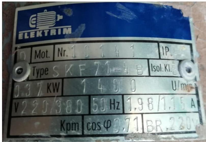
Slika 27: Pločica elektromotora Elektrim SKF 71-4B
