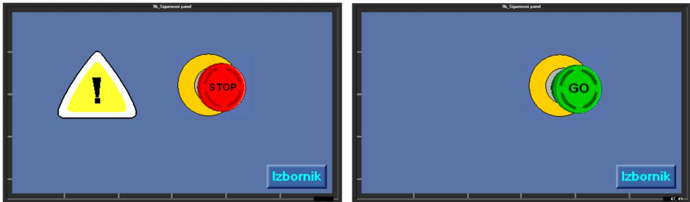
Slika 45: HMI Sigurnosni panel; lijevo gljiva pritisnuta, desno gljiva otpuštana
