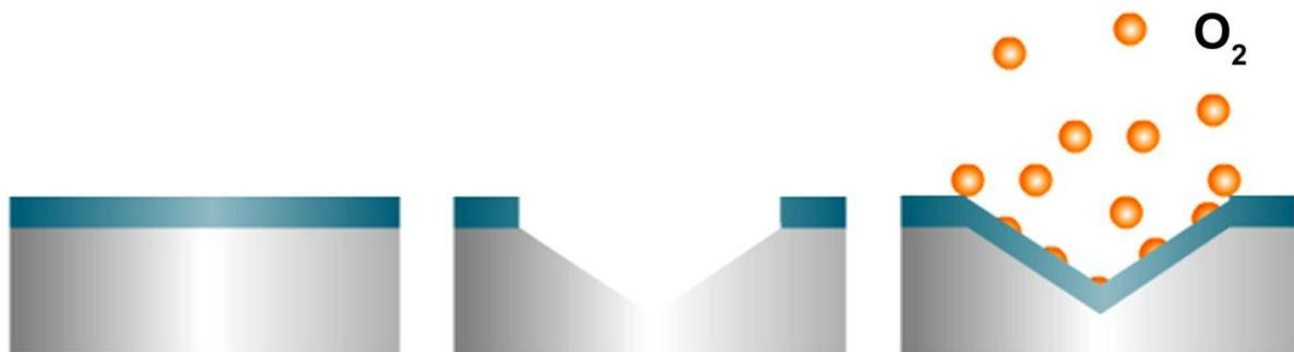
Slika 15. Shematski prikaz mehanizma samoobnavljanja (repasivacije) pasivnog filma [10]
