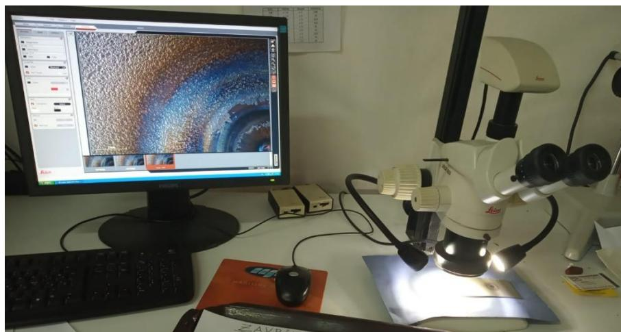
Slika 32. Stereomikroskopska analiza ispitnih uzoraka
