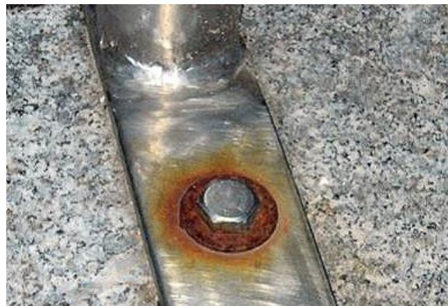
Slika 6. Primjer galvanske korozije [9]
