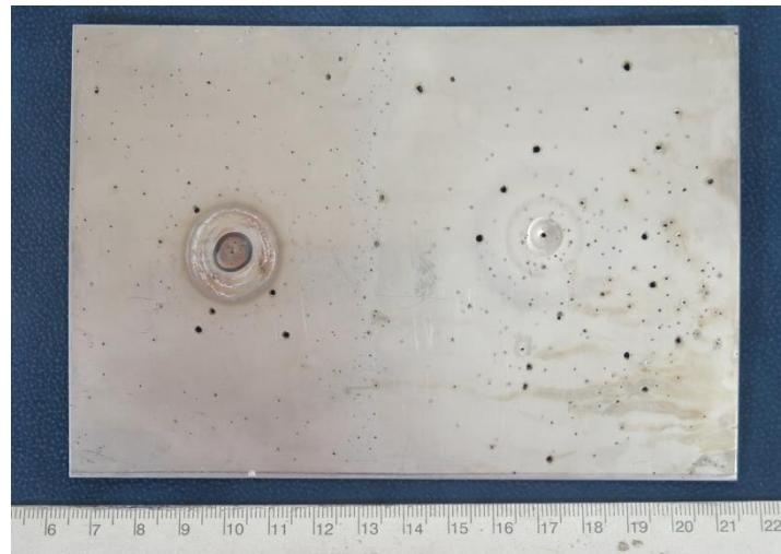
Slika 28, Uzorak čelika AISI 321 (EN 1.4541) nakon koroziskog ispitivanja. Vidljivo je osjetno oštećivanje cijele površine
