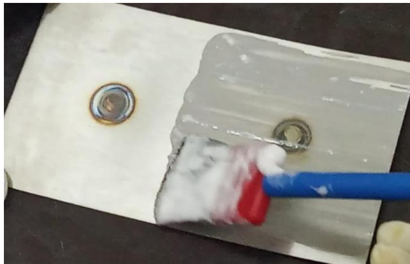
Slika 24. Naknadna obrada kemijskom metodom nagrizanja
