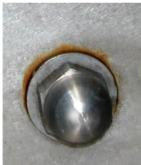
Slika 8. Primjer korozije u procjepu [13]
