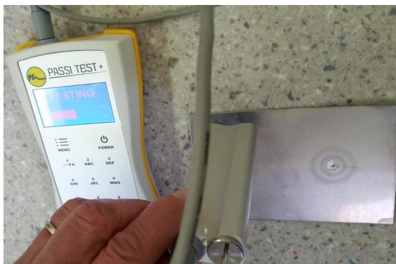
Slika 25. Ispitivanje pasivnosti površine ispitnih uzoraka uređajem Nitty Gritty
