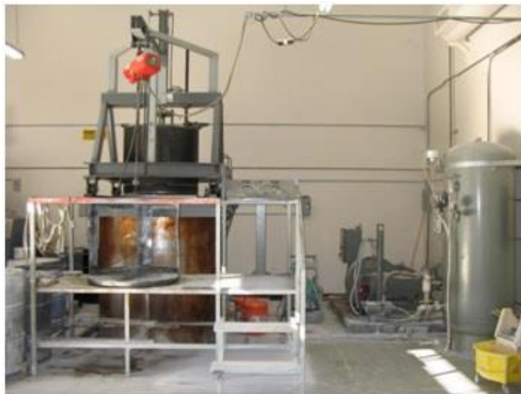
Slika 4.1. Preša za izostatičko prešanje
