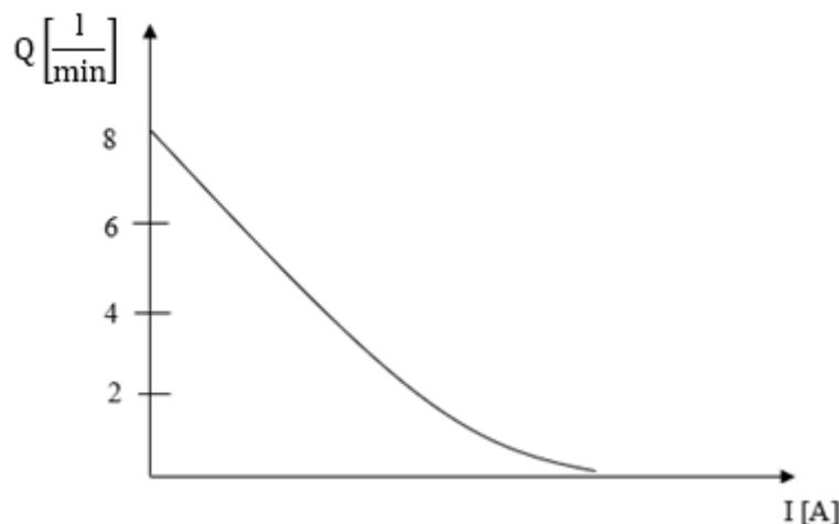
Slika 15. Dijagram protoka  $Q$  prema cilindru
