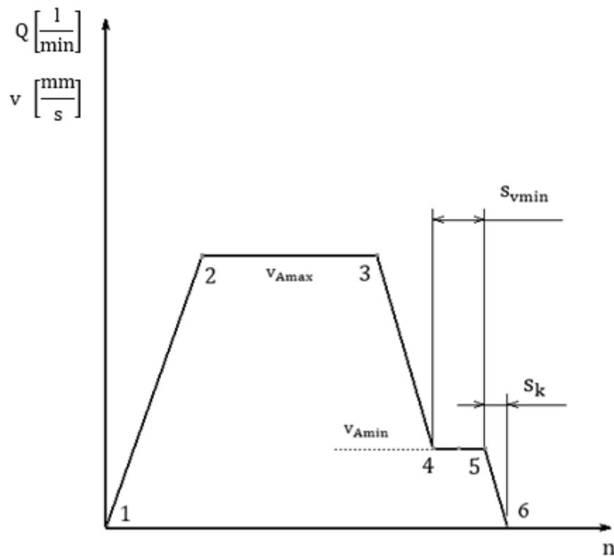
**Slika 20. Dijagram promjene brzine za gibanje A**
