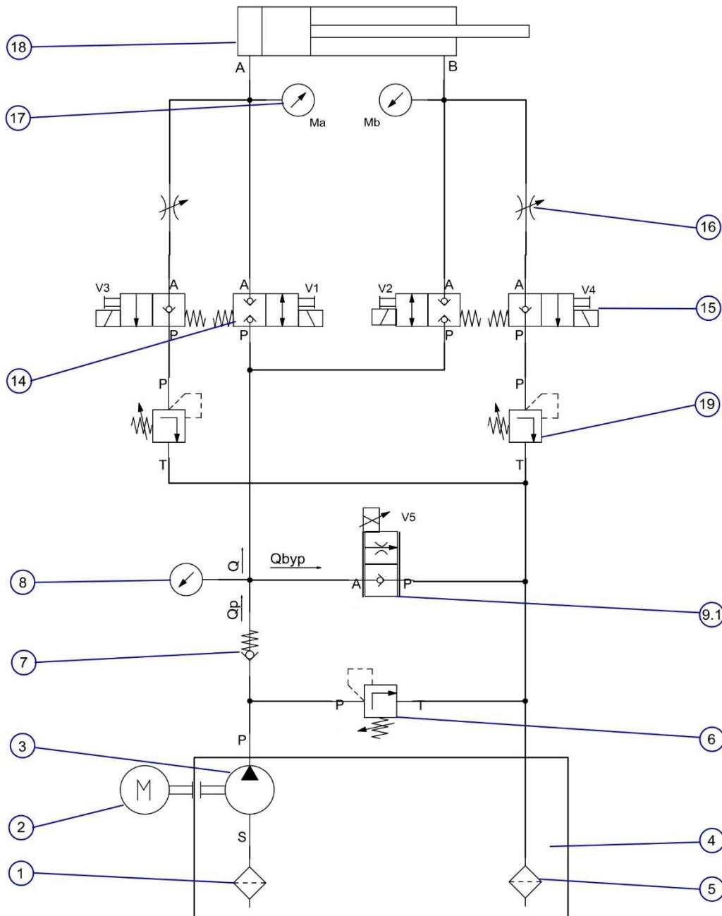
Slika 12. Hidraulička shema eksperimentalnog postava za varijantu 1.
