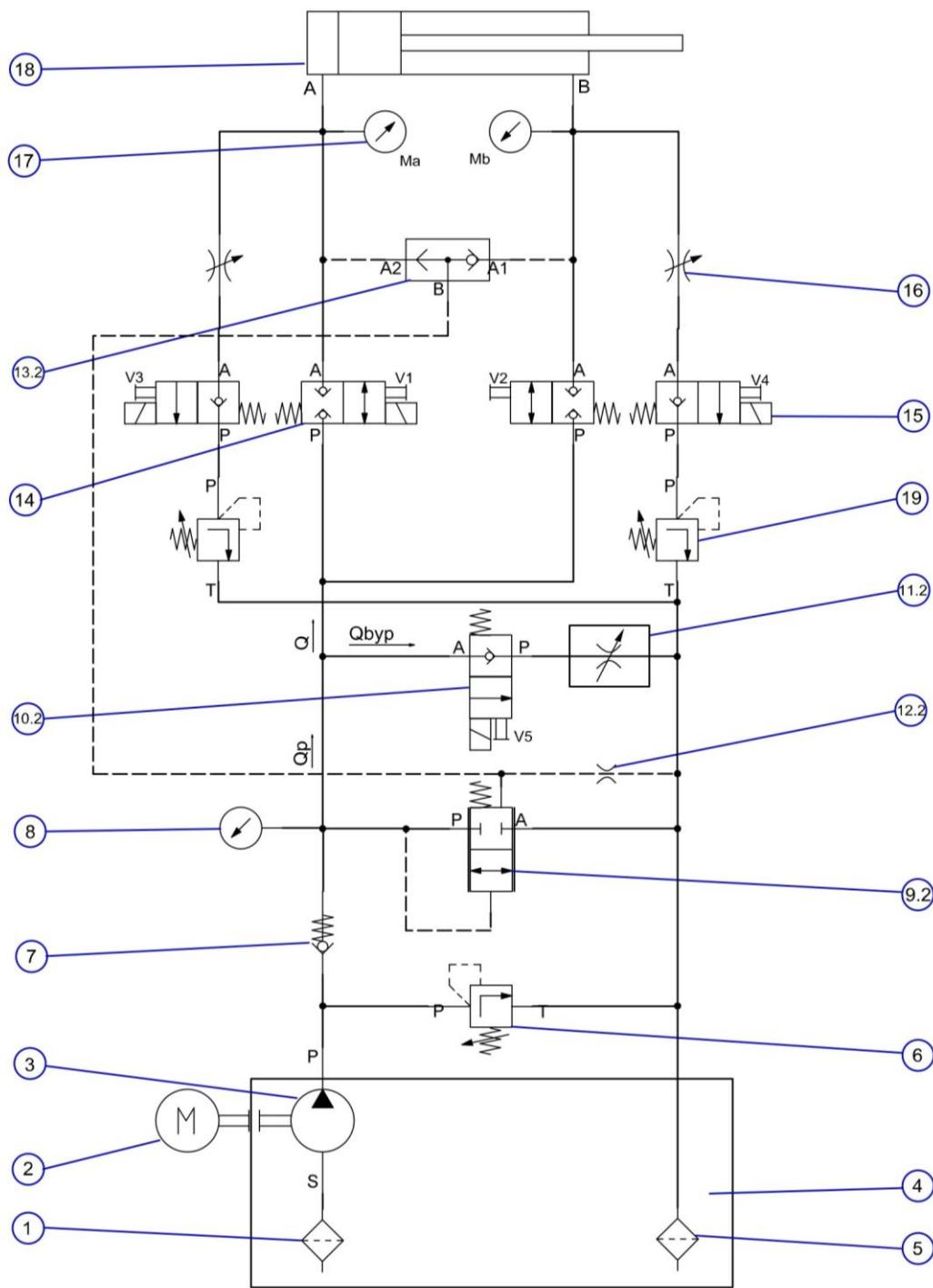
Slika 19. Hidraulička shema eksperimentalnog postava varijante 2.
