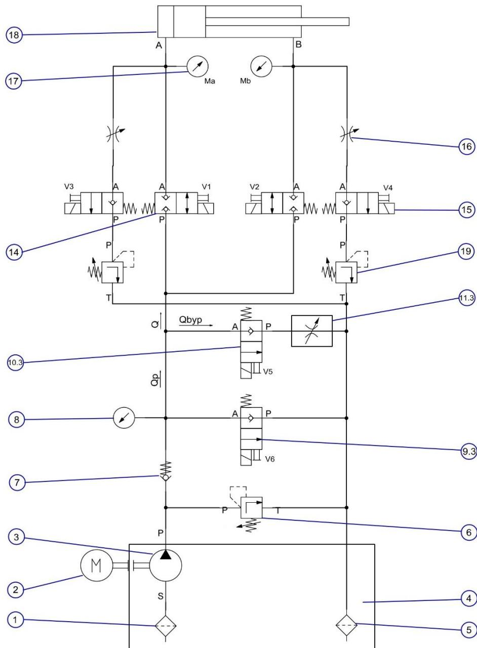
Slika 22. Hidraulička shema eksperimentalnog postava varijante 3.
