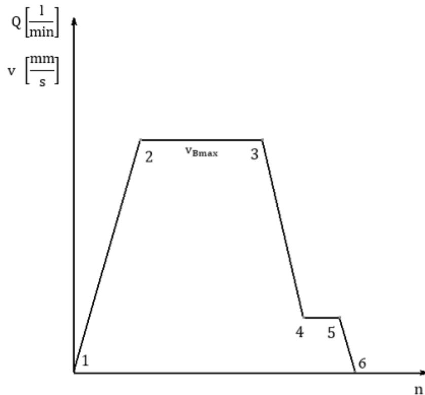
**Slika 21. Dijagram promjene brzine za gibanje B**
