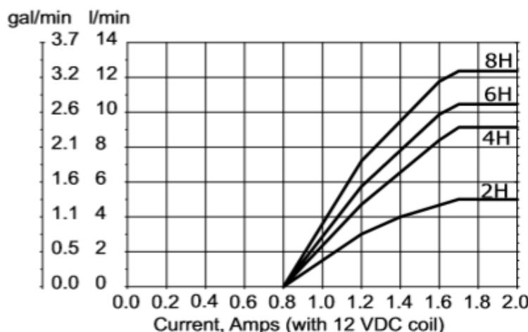
Slika 13. Dijagram struje upravljanja za napon 12 VDC
