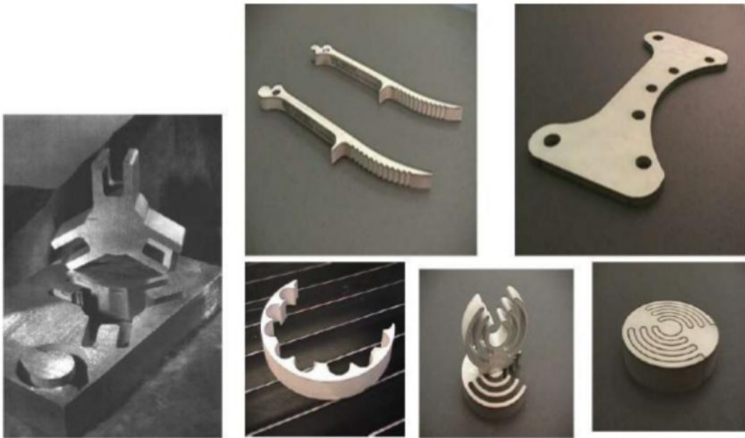
Slika 12. Dijelovi izrađeni AWJM postupkom [17]
