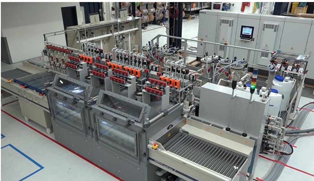
Slika 49. Sustav za PCM obradu [47]
