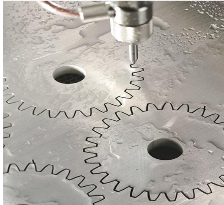
Slika 9. Obrada aluminija vodenim mlazom [14]
