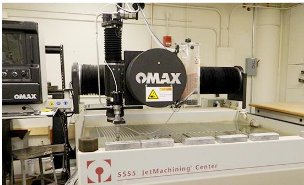
Slika 8. Sustav za obradu vodenim mlazom [13]
