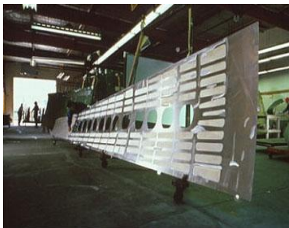
Slika 45. Prikaz dijela trupa aviona obrađenog CHM postupkom [45]
