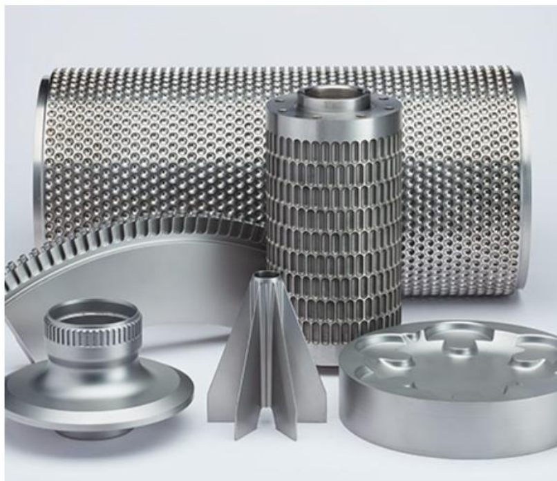
Slika 50. Prikaz nekih proizvoda obrađenih ECM postupkom [48]
