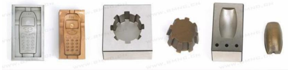
Slika 22. Prikaz izrade kalupa pomoću EDM žiga [23]
