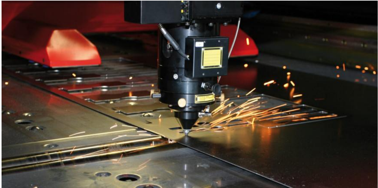
Slika 34. Laserska obrada lima [35]
