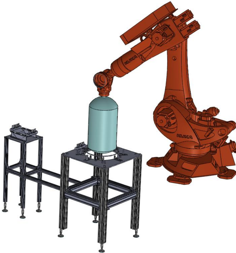
Slika 45. Sklop naprave za doziranje smole i dodavanje vlakana, spremnika i robota
