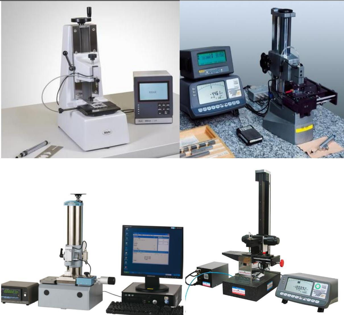
Slika 23. Elektronski komparatori (Precimar 826, Tesa UPC, GBCD-250, GBC-P300) [16]
