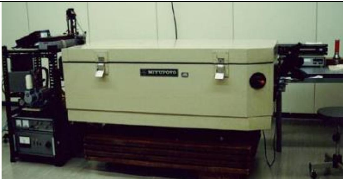
Slika 13. Interferometar za mjerjenje dugih etalona duljine [10]
