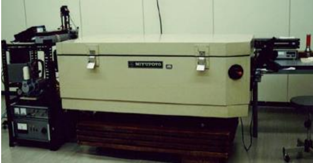
Slika 13. Interferometar za mjerenje dugih etalona duljine [10]
