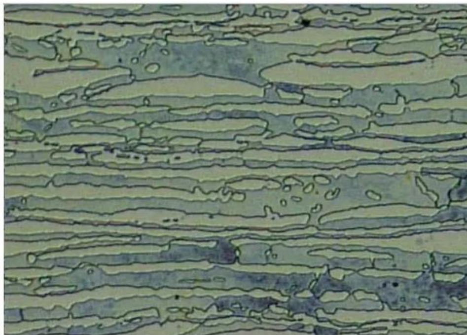
Slika 7. Mikrostruktura dupleks nehrđajućeg čelika oznake X2CrNiMoN22-5-3 [7]
