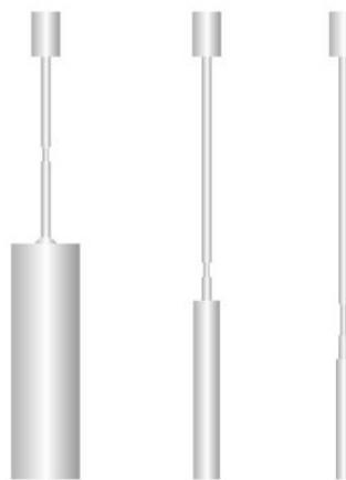
*Slika 11. Cilindrični visak [10]*
