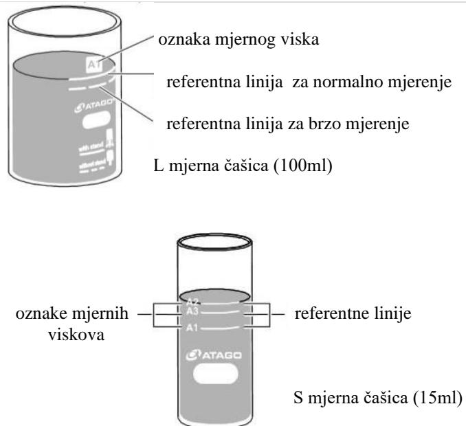
Čašica s uzorkom stavlja se na postolje i na to ide glavna mjerna jedinica. Uređaj je spremjan za mjerjenje.
