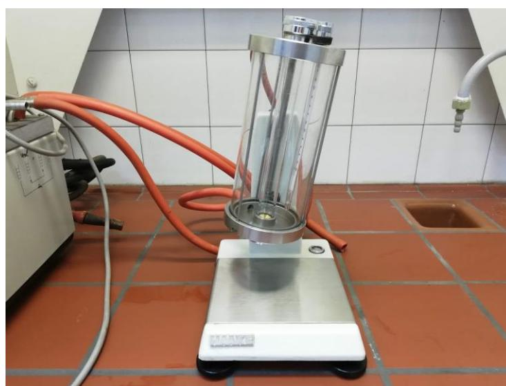
Slika 8. Höpplerov viskozimetar
