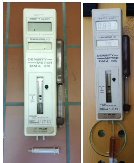
*Slika 18. Prijenosni mjerač gustoće DMA 35 i postupak mjerjenja*
