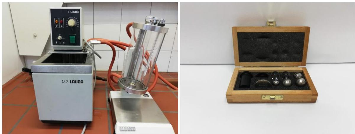
*Slika 17. Höpplerov viskozimetar s pripadajućim kuglicama*
