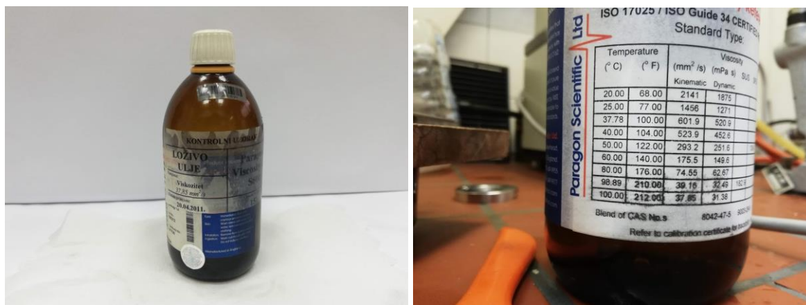
Slika 14. Kontrolni uzorak loživog ulja za kalibraciju
