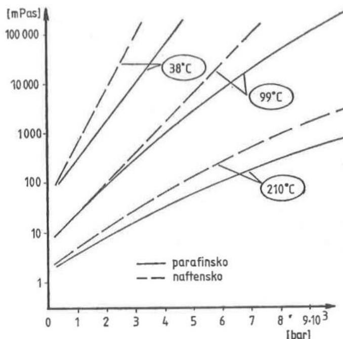
Slika 5. Ovisnost viskoznosti mineralnih ulja o tlaku [3]
