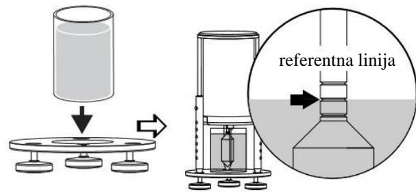
Kad je uređaj spremjan za mjerjenje, potrebno je još podesiti parametre, odnosno kombinaciju viska i čašice i odabrati željenu brzinu vrtnje.
