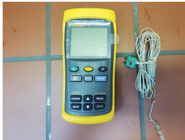
Slika 13. Fluke 53 II B termometar
