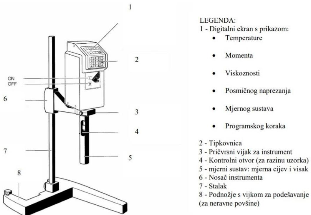
Slika 9. Rotacijski viskozimetar [5]
