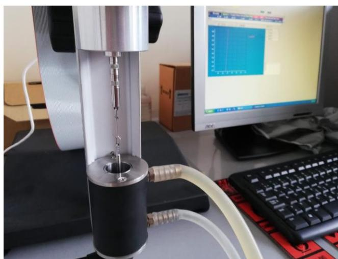
*Slika 20. Komora, cilindar i visak*
