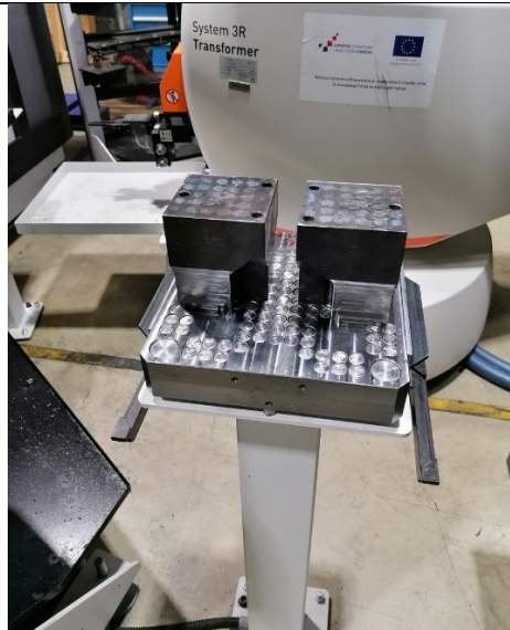
Slika 67. Umetanje obradaka na stanicu za ulaganje
