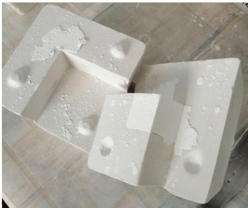
Slika 2. Otvaranje gipsanih kalupa nakon sušenja suspenzije
