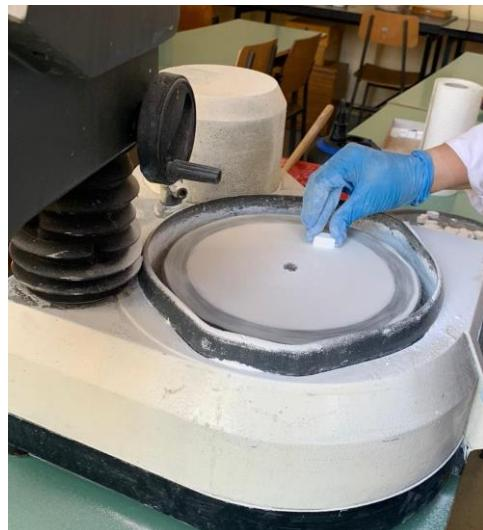
**Slika 5. Brušenje sirovaca**
