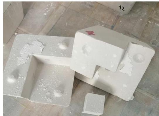
Slika 3. Vađenje stvrdnutih sirovaca iz gipsanih kalupa
