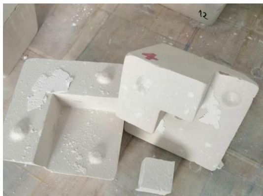
Slika 3. Vađenje stvrdnutih sirovaca iz gipsanih kalupa
