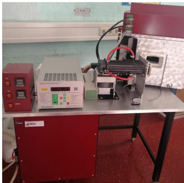
Slika 7. Hibridna peć za mikrovalno sinteriranje
