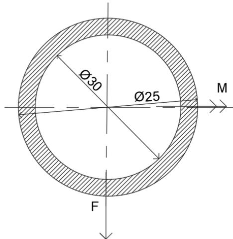
**Slika 23. Opterećenje zavara**
