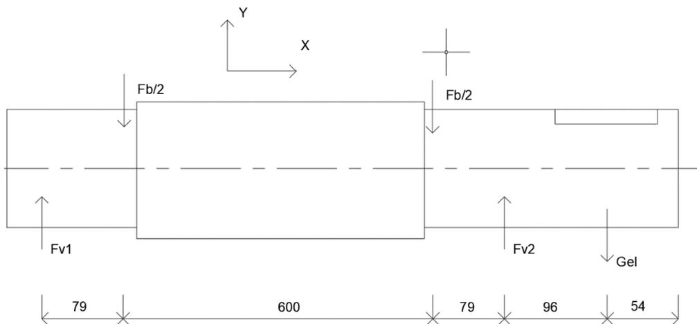
Slika 16. Opterećenja na vratilu u vertikalnoj ravnini
