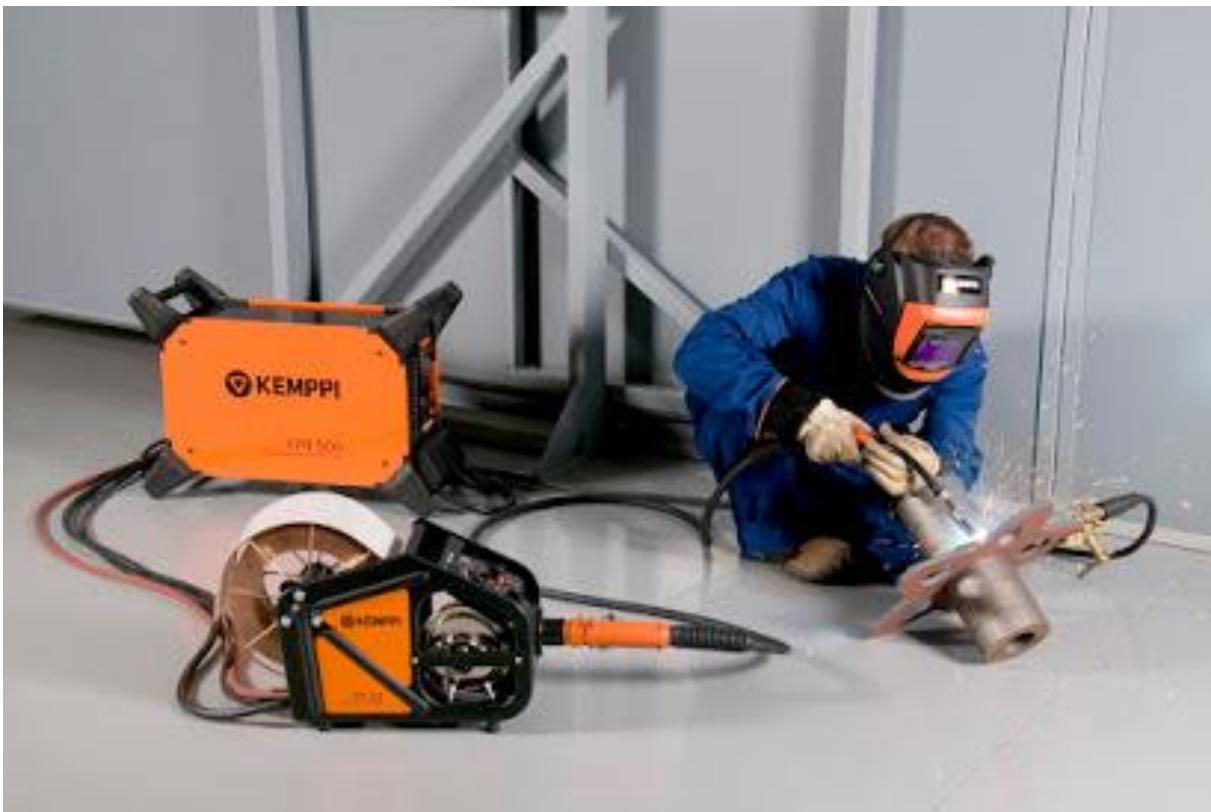
Slika 2. PoluautomatskoMIG/ MAG zavarivanje [10]
