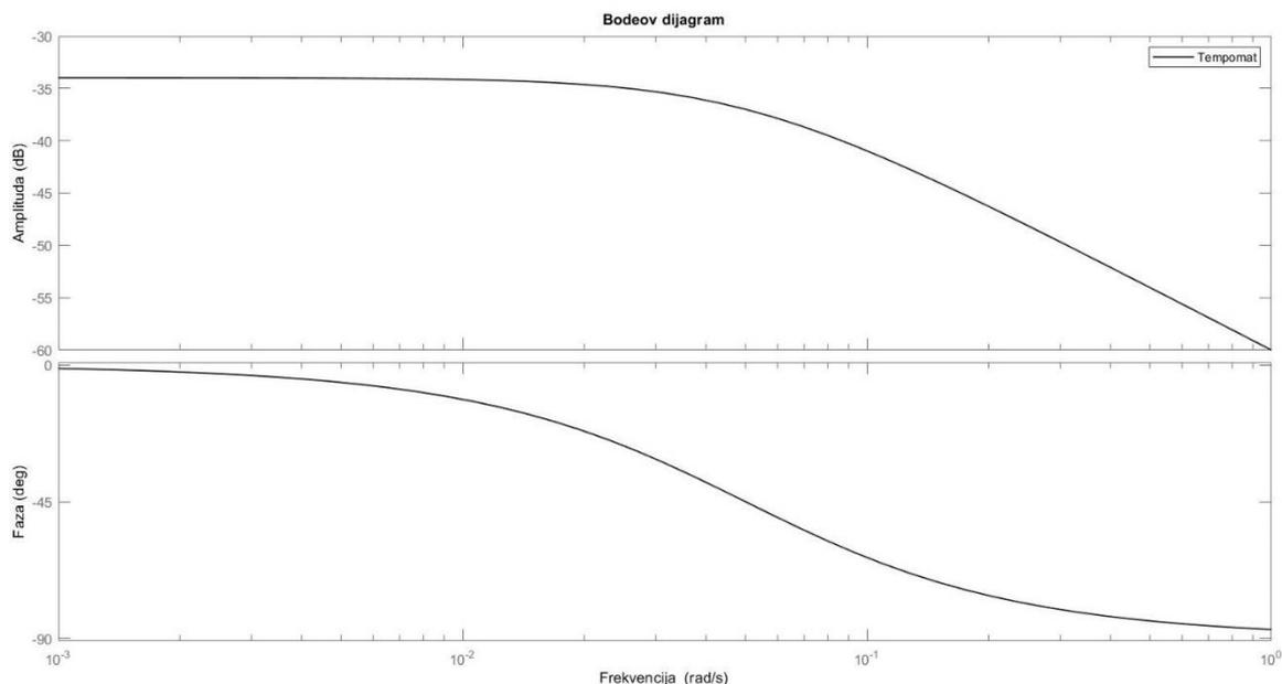
**Slika 3.5. Bodeov dijagram nereguliranog sistema - Tempomat**
