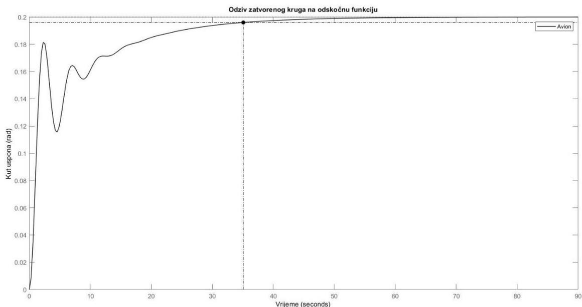
**Slika 3.29. Odziv zatvorenog sistema na odskočnu funkciju – Avion**
