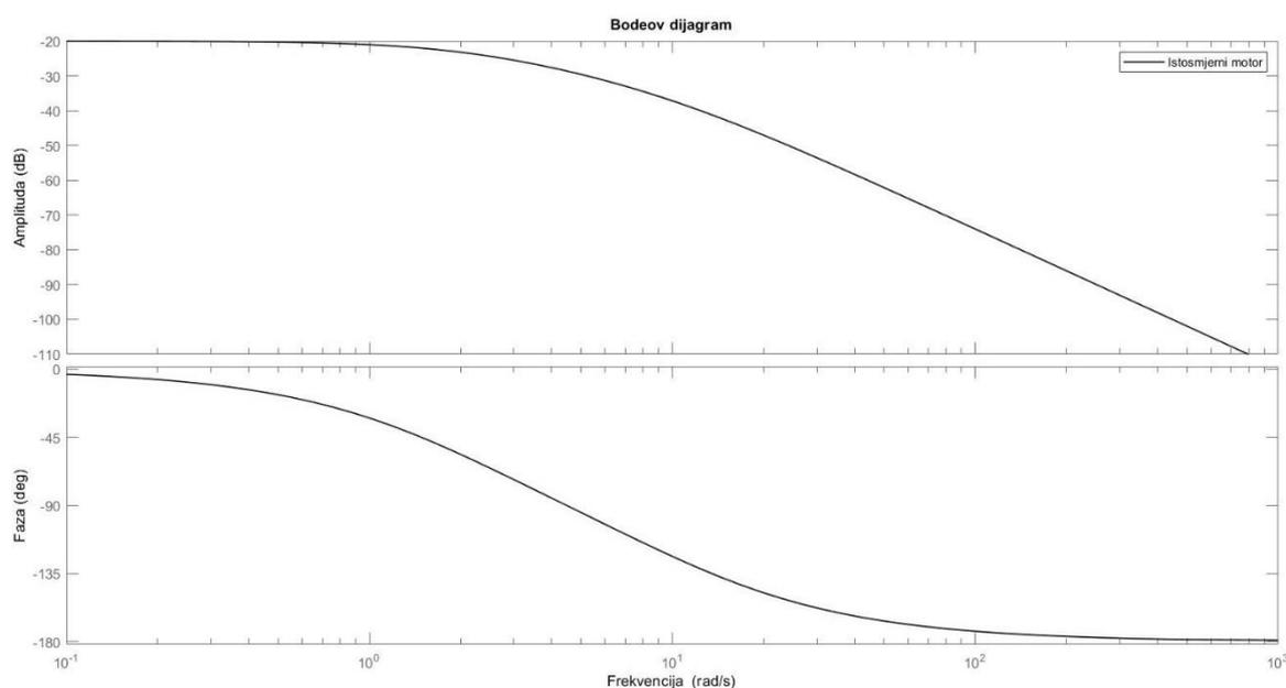
**Slika 3.12. Bodeov dijagram nereguliranog kruga – Istosmjerni motor**
