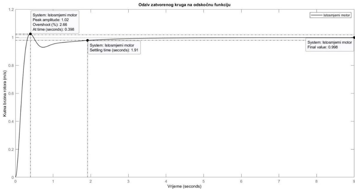
**Slika 3.11. Odziv zatvorenog kruga na odskočnu funkciju – Istosmjerni motor**
