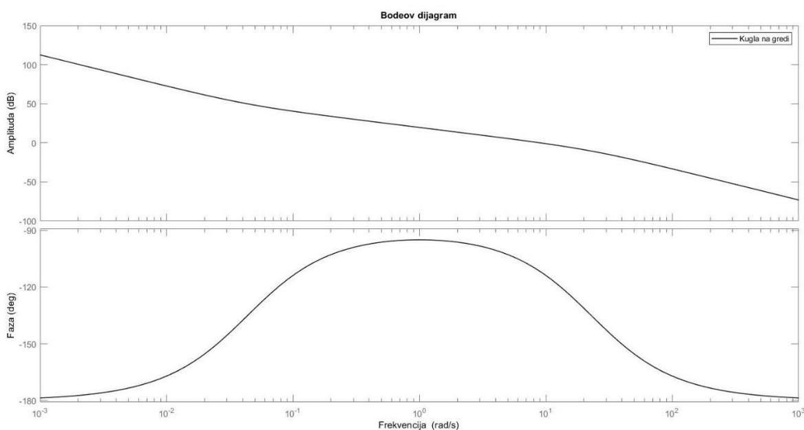
**Slika 3.20. Bodeov dijagram sustava s Lead regulatorom – Kugla na gredi**
