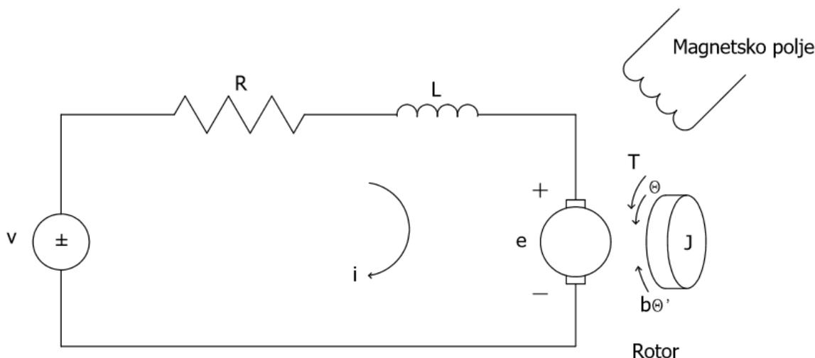
**Slika 3.8. Skica dinamičkog sustava – Istosmjerni motor**
