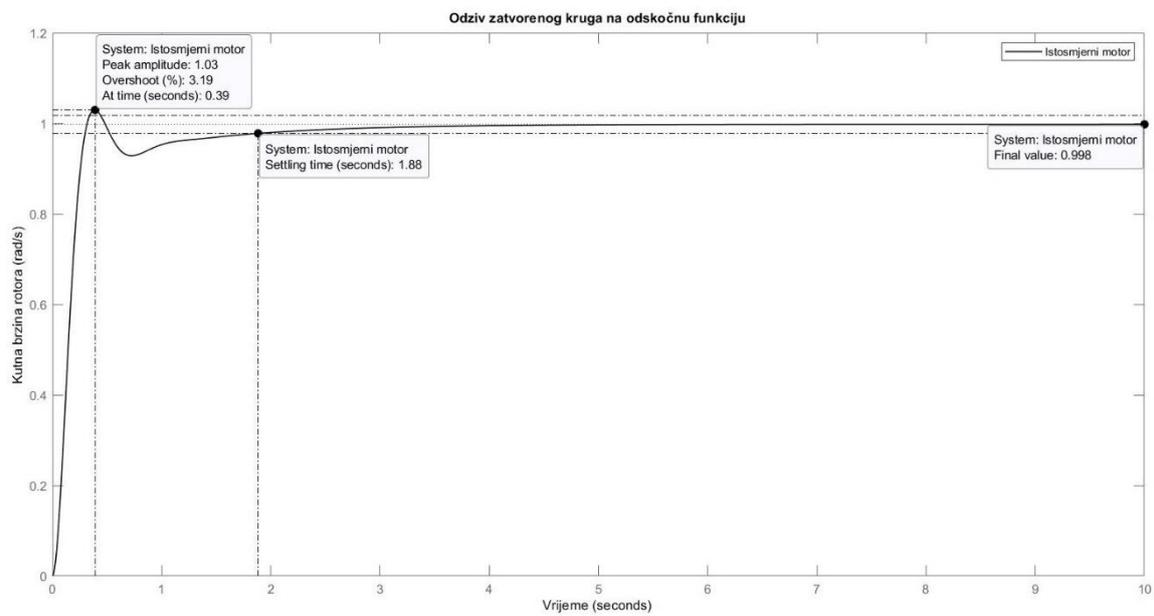
**Slika 3.14. Odziv zatvorenog kruga na odskočnu funkciju – Istosmjerni motor**
