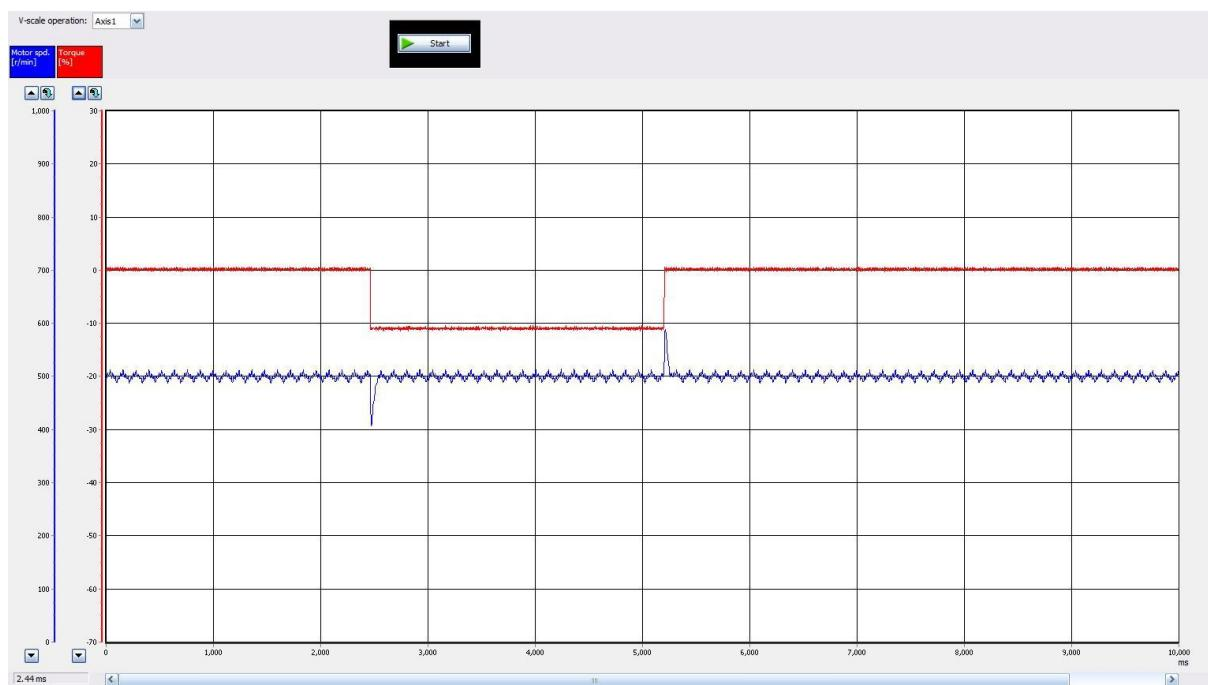
Slika 55. Mjerenje odziva pri 10% nazivnog momenta i 500 o/min
