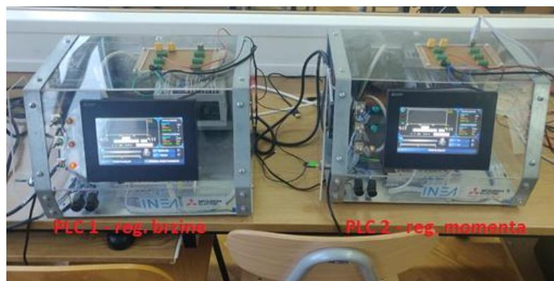
Slika 36. PLC makete sa servo pojačalima i HMI sučeljem
