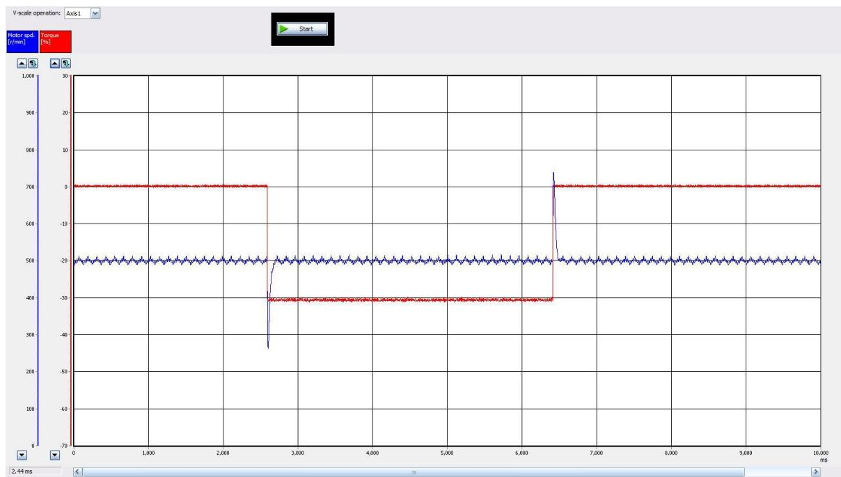
**Slika 57. Mjerenje odziva pri 30% nazivnog momenta i 500 o/min**
