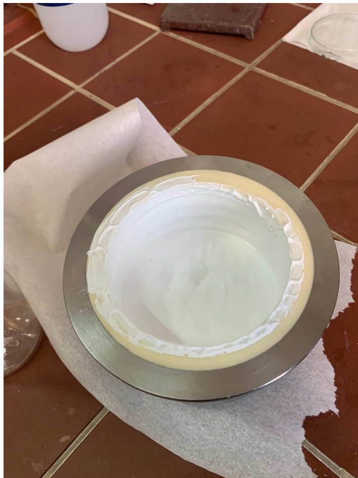
Slika 25. Smjesa nakon homogenizacije u planetarnom kugličnom mlinu Retsch PM 100
