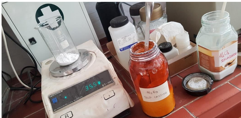
Slika 14. Tehnička vaga „Tehnica ET-1111“
