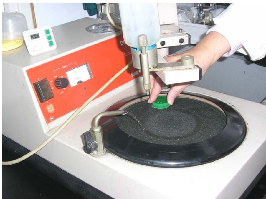
Slika 24 Uređaj za brušenje
