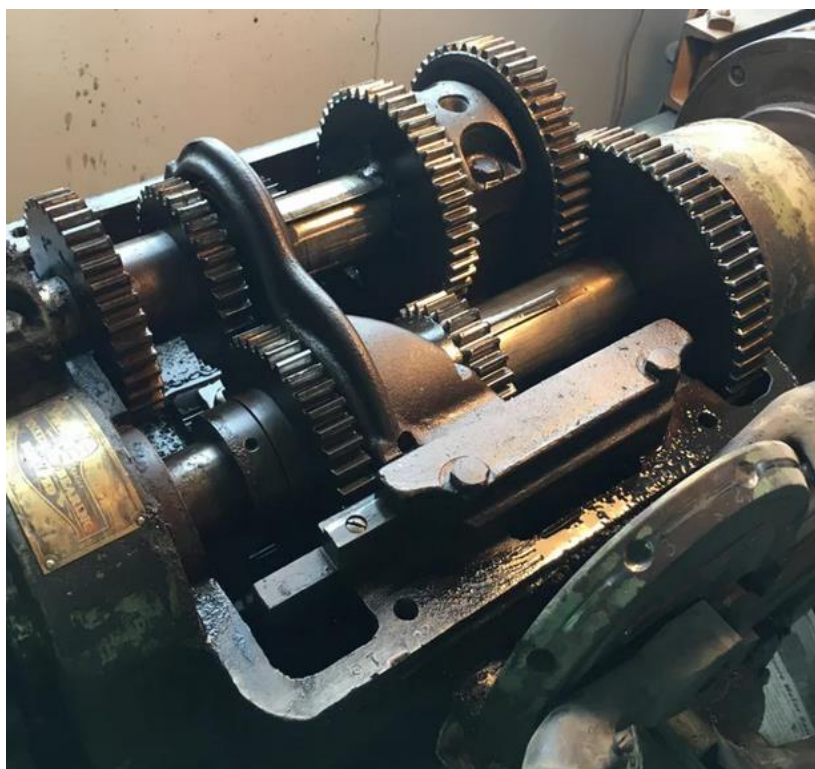
Slika 8. Zupčanički prijenosnik na tokarskom stroju
