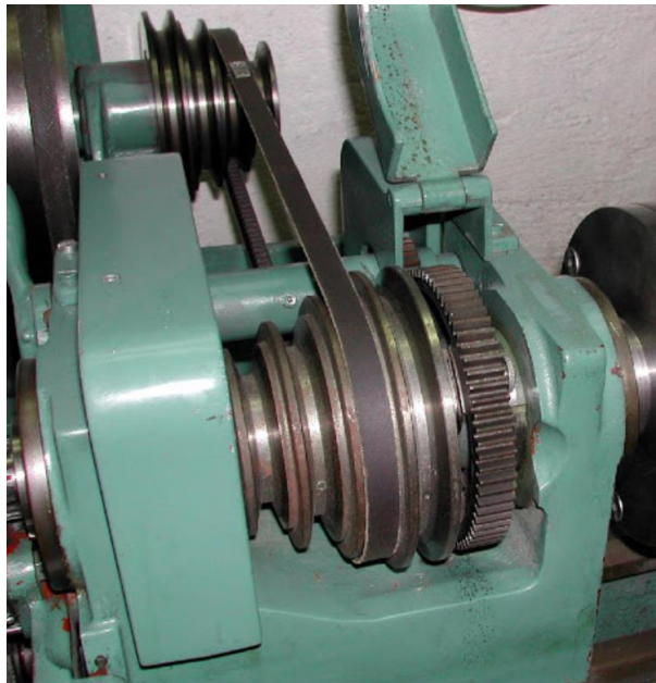
Slika 6. Tokarski stroj s prijenosom putem klinastog remena
