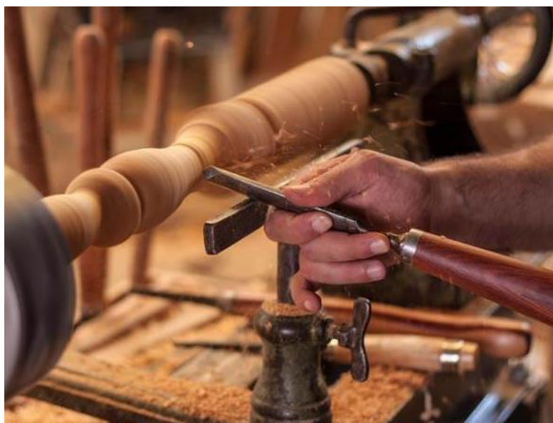
Slika 3. Obrada drva na tokarskom stroju
