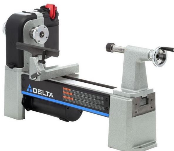
Slika 4. Mala tokarilica sa motorom ispod stroja
