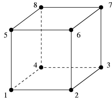
Slika 8. Osnovni prizmatični konačni element (C3D8) [7]
