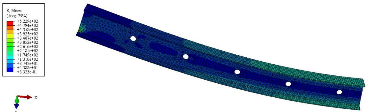
Slika 42. Raspodjela ekvivalentnih naprezanja prema von Misesu za  $D/h = 0,2$  u MPa
