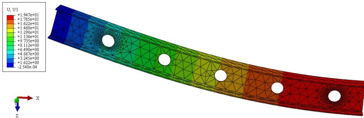
Slika 46. Raspodjela pomaka u smjeru osi z za  $D/h = 0,4$  u mm
