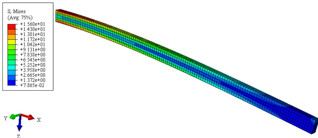
**Slika 18.** Raspodjela ekvivalentnog naprezanja prema von Misesu za diskretizaciju s 1875 C3D8R konačnih elemenata u MPa
