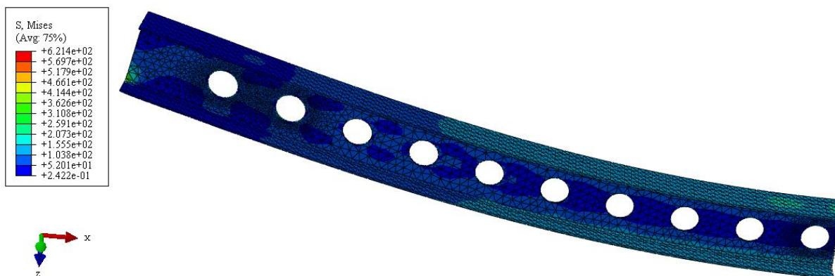
**Slika 53. Raspodjela ekvivalentnih naprezanja prema von Misesu za  $\delta/h = 0,53$  u MPa**
