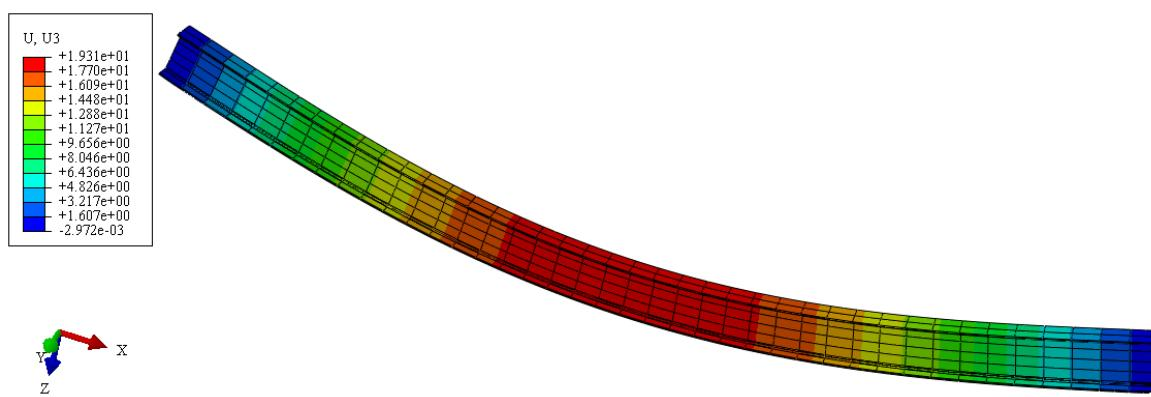
**Slika 34. Raspodjela pomaka u smjeru osi z dobivenih diskretizacijom s 1600 C3D20R konačnih elemenata u mm**
