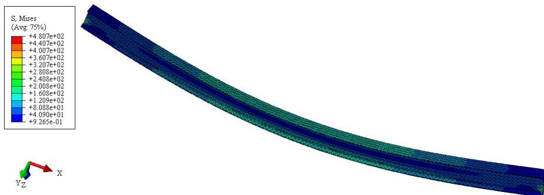
Slika 31. Raspodjela ekvivalentnih naprezanja prema von Misesu dobivenih diskretizacijom s 13667 C3D10 konačnih elemenata u MPa
