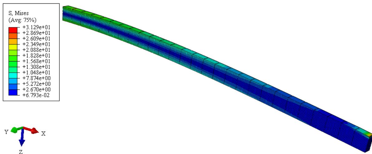
**Slika 19.** Raspodjela ekvivalentnog naprezanja prema von Misesu za diskretizaciju s 405 C3D20R konačnih elemenata u MPa
