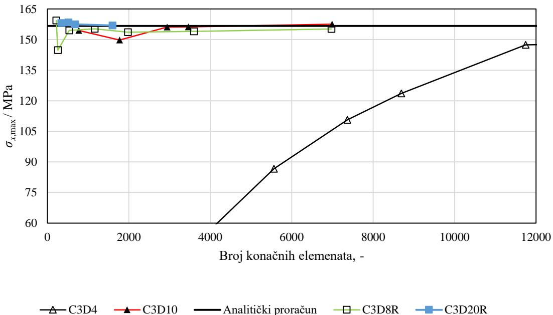
Slika 35. Konvergencija maksimalnih ekvivalentnih naprezanja prema von Misesu na mjestu  $L/2$  u MPa
