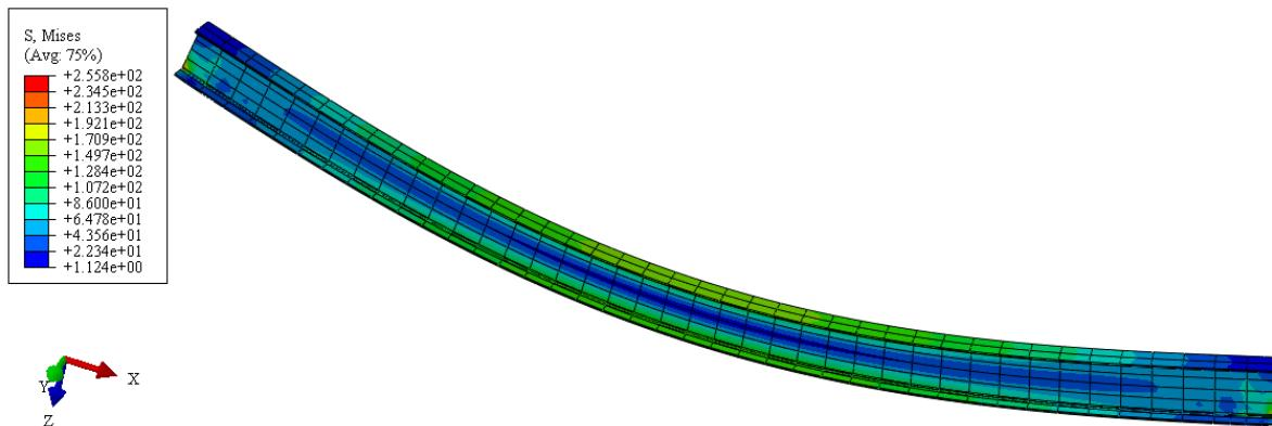
**Slika 32. Raspodjela ekvivalentnih naprezanja prema von Misesu dobivenih diskretizacijom s 1600 C3D20R konačnih elemenata u MPa**
