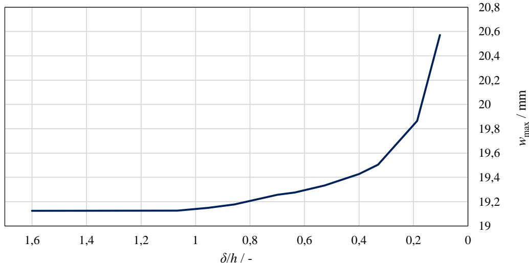
**Slika 59. Promjena progiba u smjeru osi z na mjestu  $L/2$  u ovisnosti s razmaka između otvora u mm**
