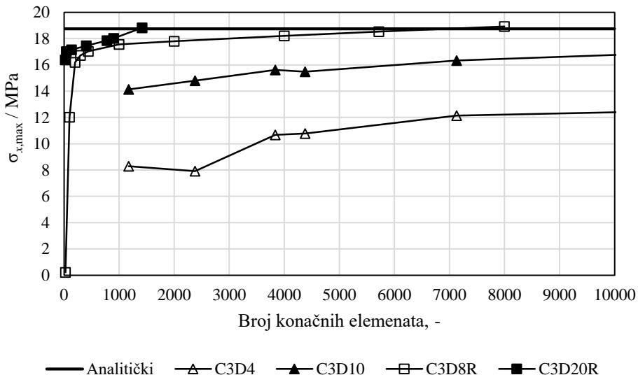
Slika 24. Konvergencija maksimalnog ekvivalentnog naprezanja prema von Misesu u MPa
