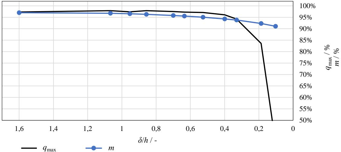
**Slika 58. Usporedba promjene mase i dopuštenog opterećenja u ovisnosti s razmaka između otvora u %**
