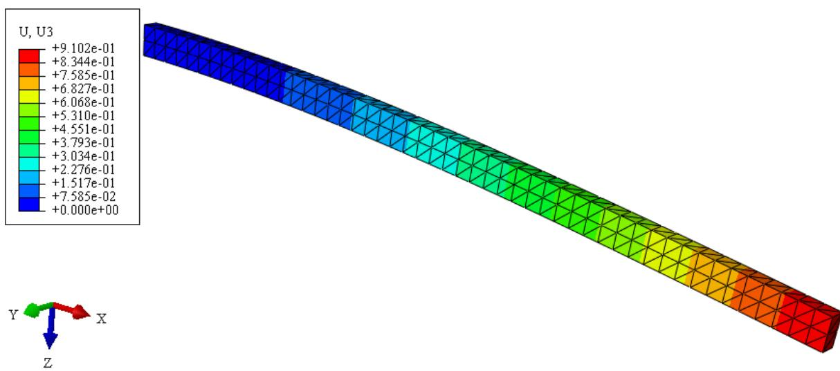
**Slika 20.** Iznos i raspodjela pomaka na konzoli za diskretizaciju s 1175 C3D4 konačnih elemenata u mm
