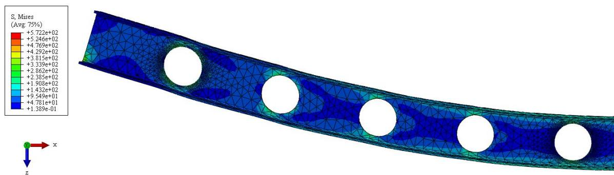
Slika 44. Raspodjela ekvivalentnih naprezanja prema von Misesu za  $D/h = 0,7$  u MPa
