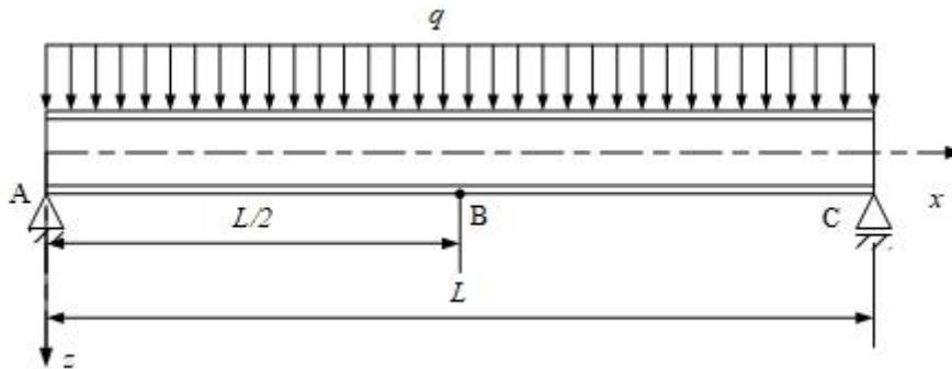
Slika 27. Opterećenje standardnog IPE 300 profila za analizu
