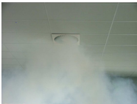
Slika 24. Eksperimentalno mjerenje, difuzor bez prstena [2]
