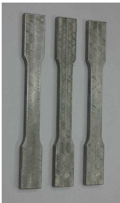
Slika 18. Ispitni uzorci a) iz konstrukcijskog čelika i b) iz nodularnog lijeva
