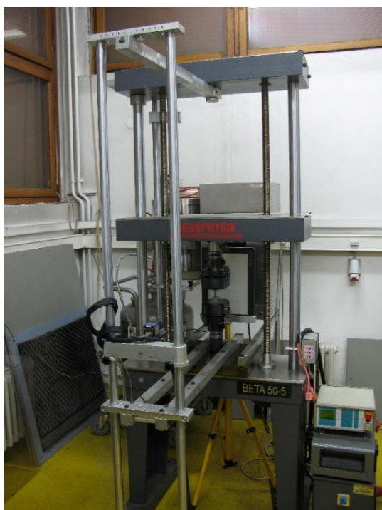
Slika 19. a) Eksperimentalni postav za provedbu statičkog vlačnog testa i b) epruveta s postavljenim markerima za mjerenje pomaka
