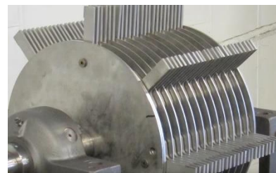
Slika 23. Rotor s kruto vezanim čekićima
