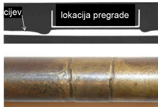
Slika 10. Oštećenja cijevi u neposrednoj blizini pregrade [12]
