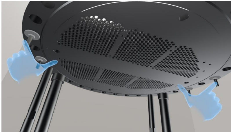
Slika 94. Obuhvaćanje krajnjih strana prirubnica s njene bočne strane
