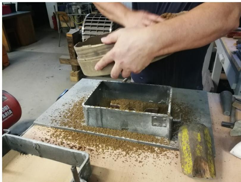
Slika 35. Nasipavanje modelnom kalupnom mješavinom
