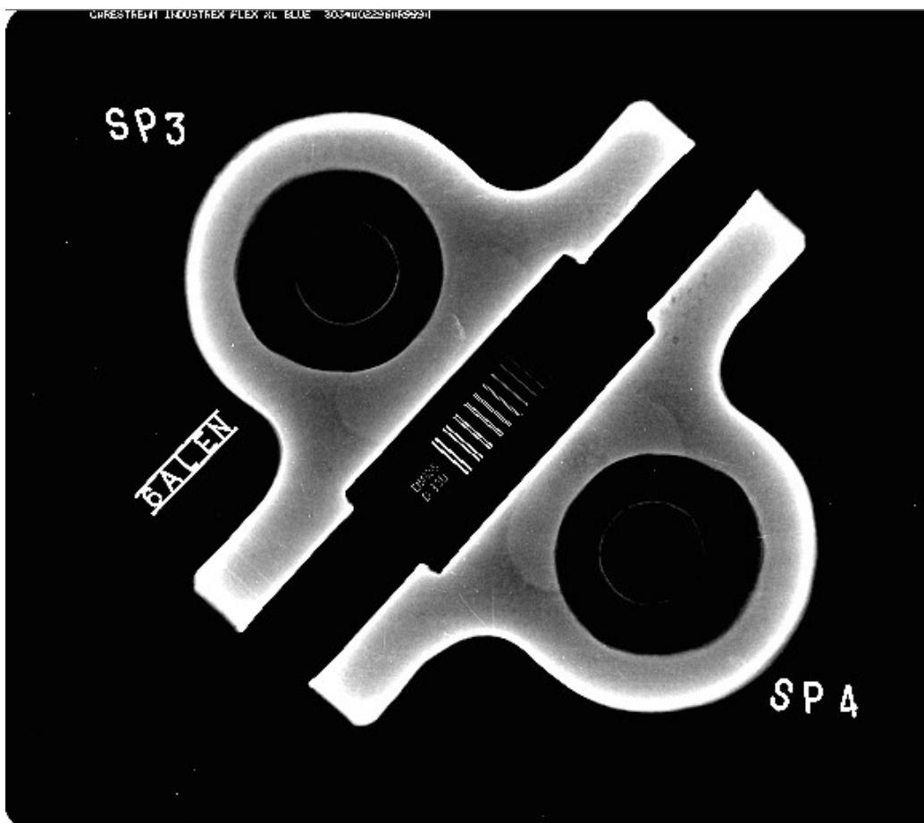
Slika 61. Radiogram odljevaka lijevanih s jednim središnjim pojilom
