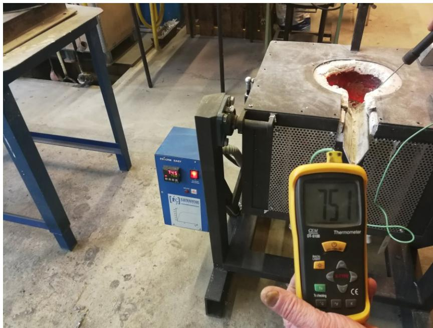
Slika 50. Temperatura taljevine u peći
