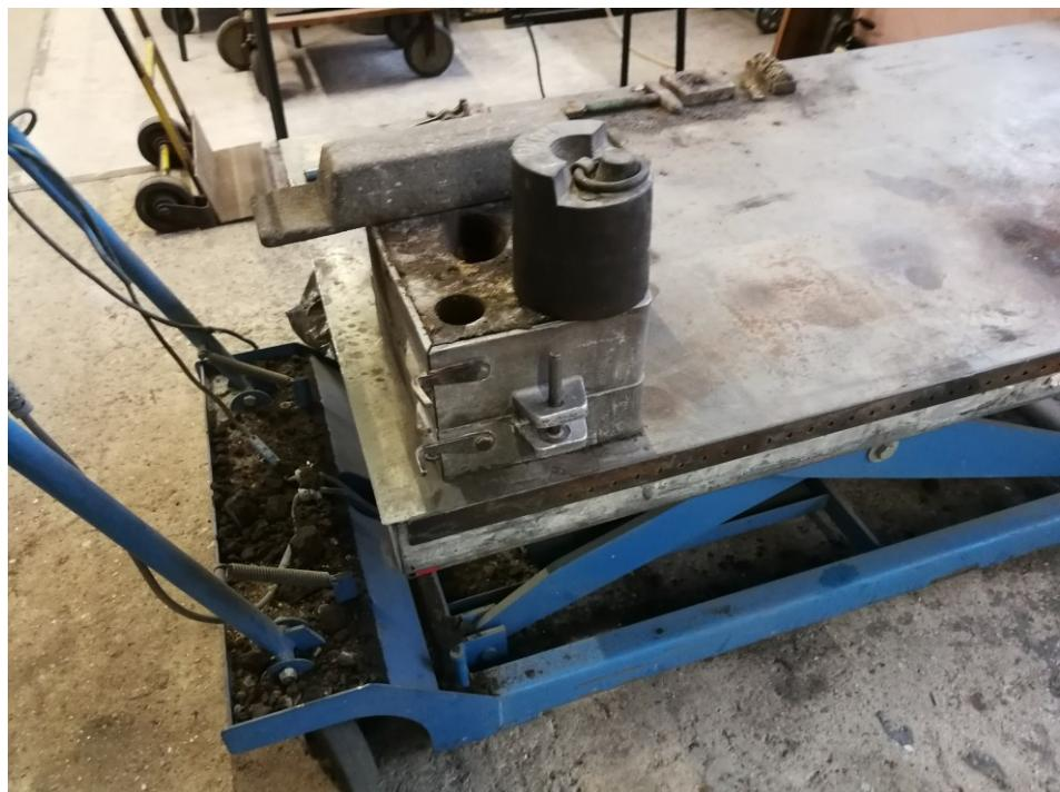
Slika 49. Gotov kalup spreman za lijevanje
