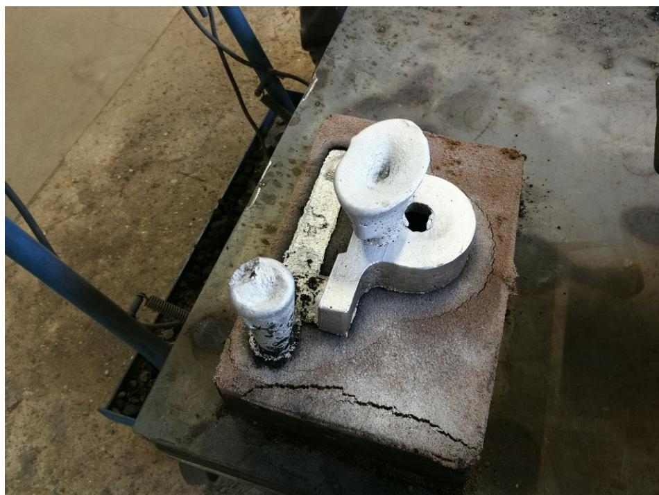
Slika 55. Odljevak i uljevni sustav
