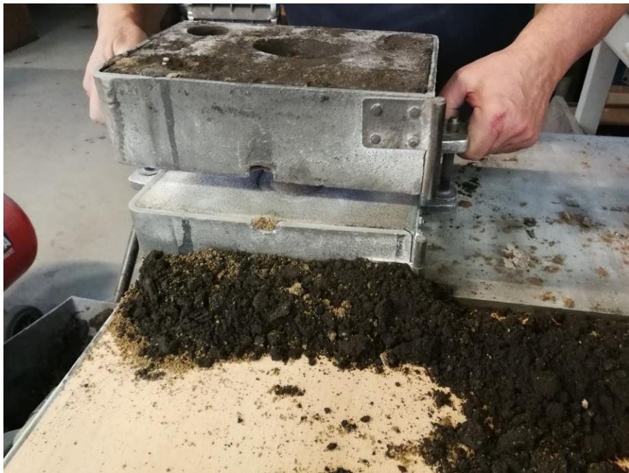
Slika 48. Zatvaranje kalupa prije lijevanja
