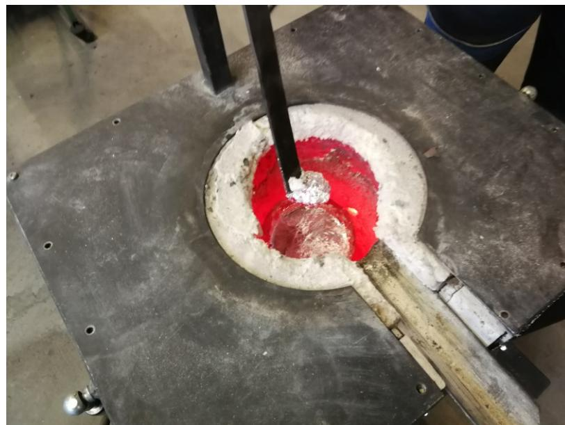
Slika 51. Uklanjanje troske sa površine taljevine
