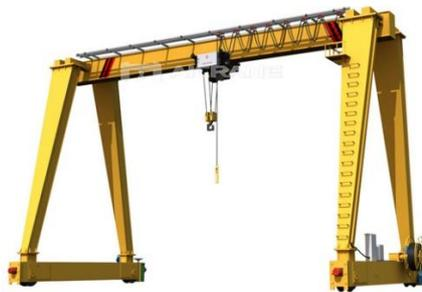
Slika 2. Portalni granik s jednim glavnim nosačem
