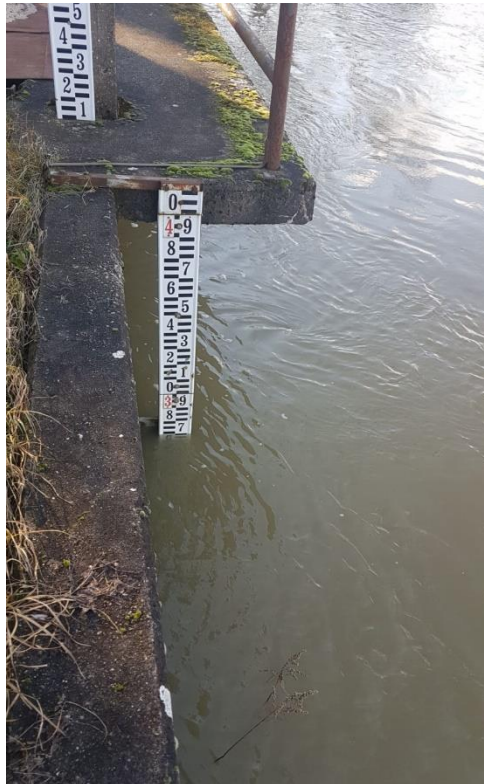
Slika 3. Štapno mjerilo dubine
