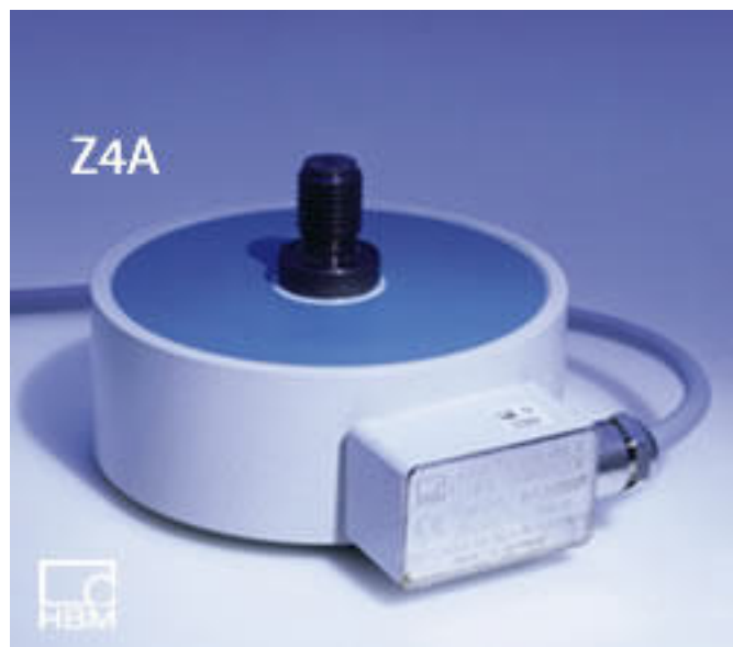
Slika 17 – Posrednički etalon Z4A [17]
