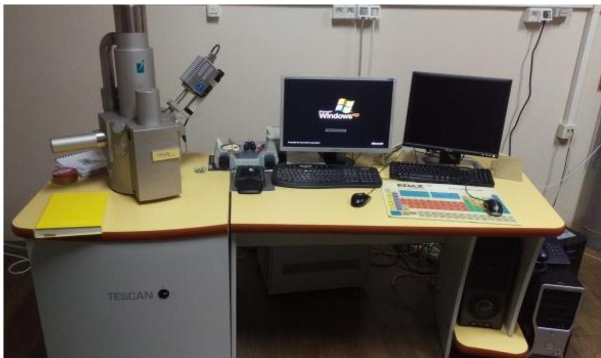
**Slika 19. Skenirajući elektronski mikroskop (SEM) Tescan**
