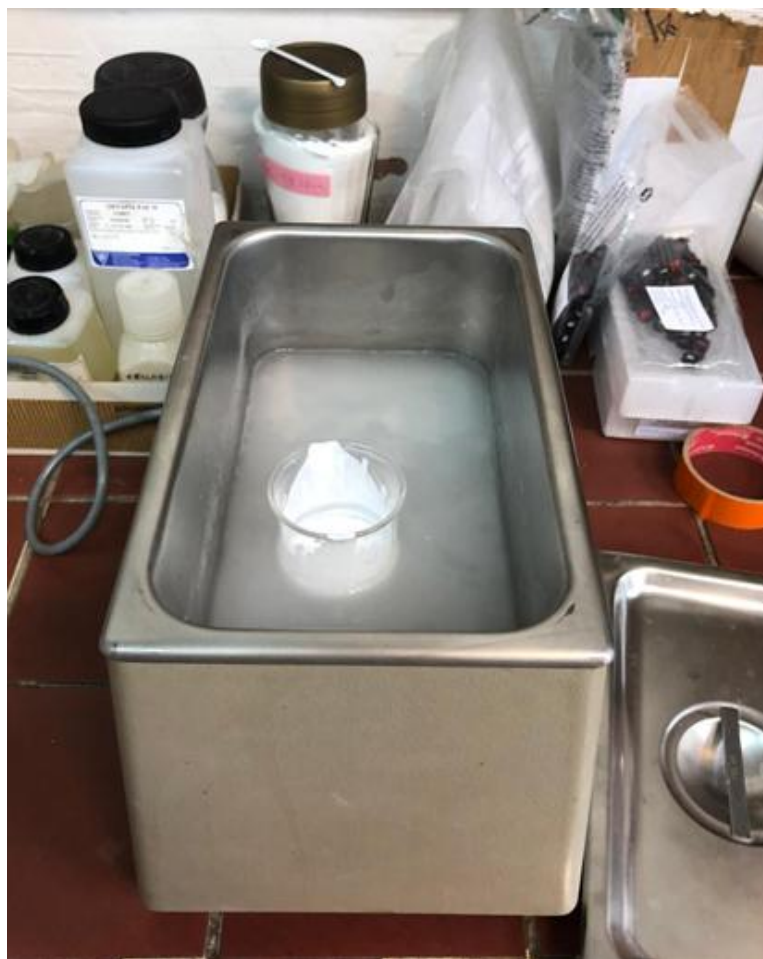
Slika 13. Suspenzija u ultrazvučnoj kupelji BRANSONIC 220 (Branson Ultrasonics Corp., SAD)
