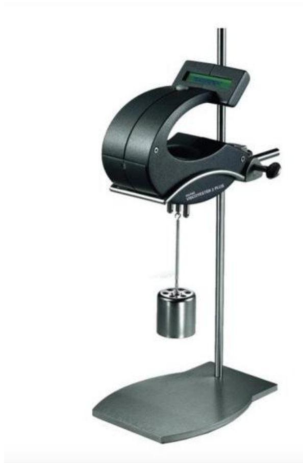
Slika 9. Uređaj za mjerenje viskoznosti (rotacijski viskozimetar) [16]
