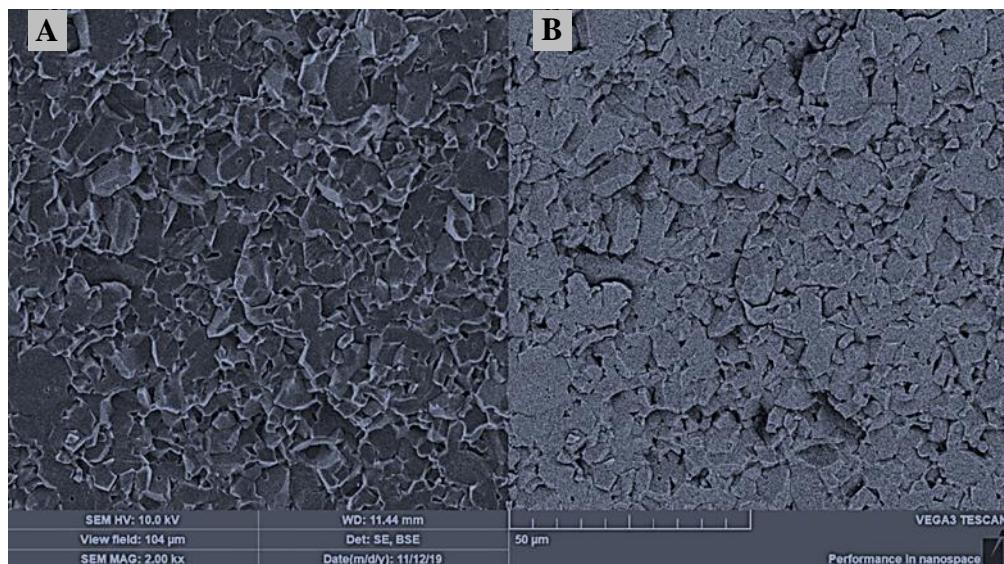
**Slika 29.** SEM snimke prijelomne površine sinteriranih uzoraka monolitne  $\text{Al}_2\text{O}_3$  dobivene (A) detektorom sekundarnih elektrona ili SE (eng. Secondary Electron), (B) detektorom povratnog raspršenja ili BSE (eng. Back Scatter Electron)
