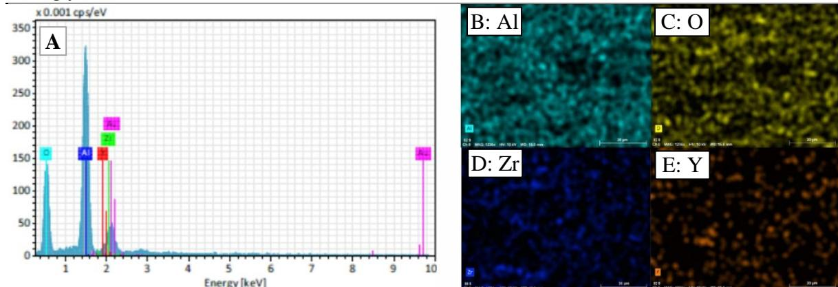
**Slika 35. EDS mapiranje prijelomne površine sinteriranih uzoraka kompozitne  $\text{Al}_2\text{O}_3$ - $\text{ZrO}_2$  keramike (uzorak s 90%  $\text{Al}_2\text{O}_3$  + 10%  $\text{ZrO}_2$ ); (A) EDS spektar; raspodjela kemijskih elemenata: (B) aluminij; (C) kisik; (D) cirkonij; (E) itrij**
