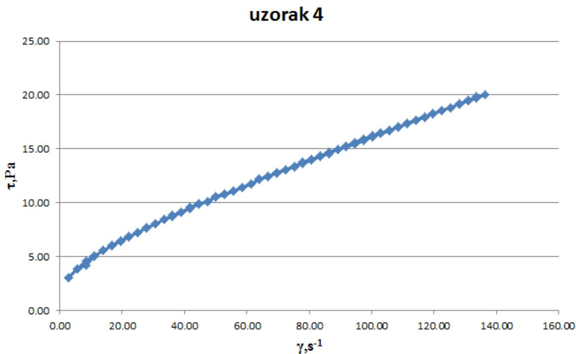
**Slika 28. Rezultati reoloških mjerena na realnim uzorcima suspenzija: ovisnost smičnog naprezanja o brzini smicanja za 90%Al<sub>2</sub>O<sub>3</sub> + 10%ZrO<sub>2</sub> (uzorak 4)**
