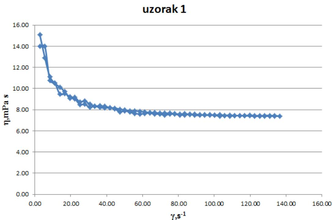
Slika 21. Rezultati reoloških mjerena na realnim uzorcima suspenzija: ovisnost prividne viskoznosti o brzini smicanja za 100%Al<sub>2</sub>O<sub>3</sub> (uzorak 1)
