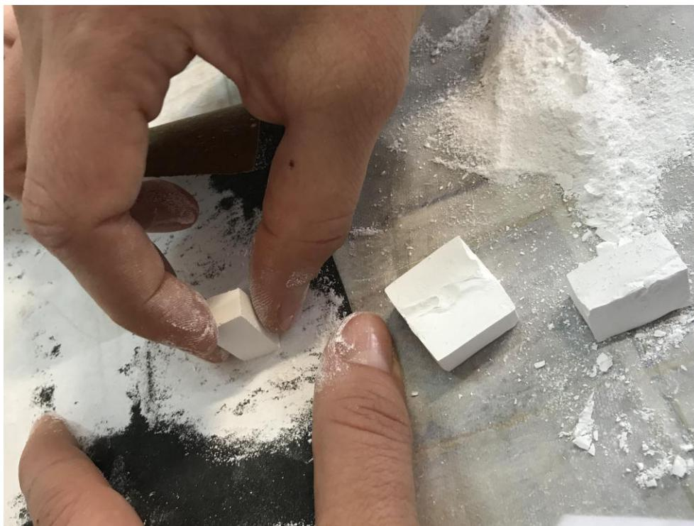
**Slika 16.Brušenje sirovaca (zelena obrada)**
