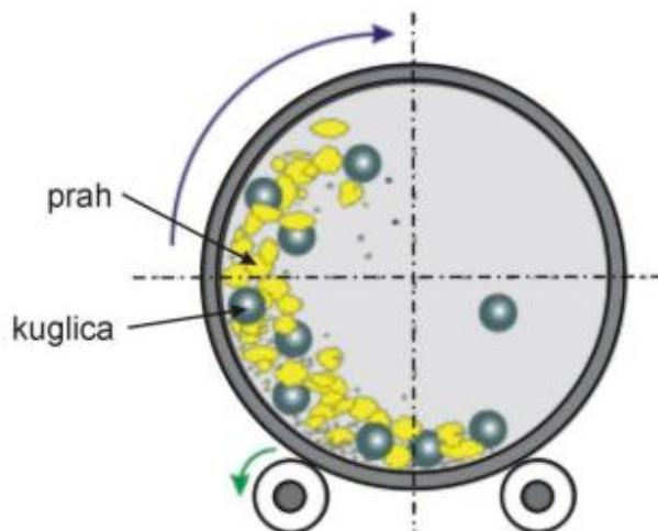
Slika 4. Proces mljevenja u kugličnom mlinu [7]
