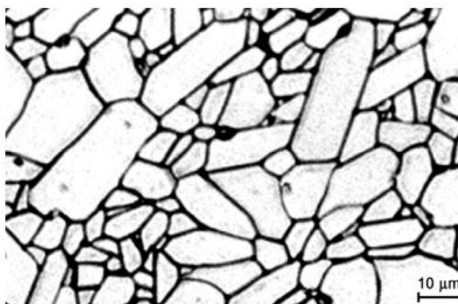
Slika 5. Snimka mikrostrukture aluminijeva oksida (99,7%) [4]
