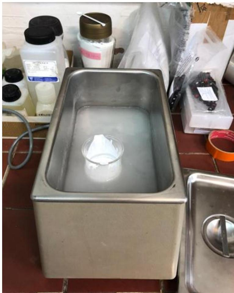
**Slika 13. Suspenzija u ultrazvučnoj kupelji BRANSONIC 220 (Branson Ultrasonics Corp., SAD)**
