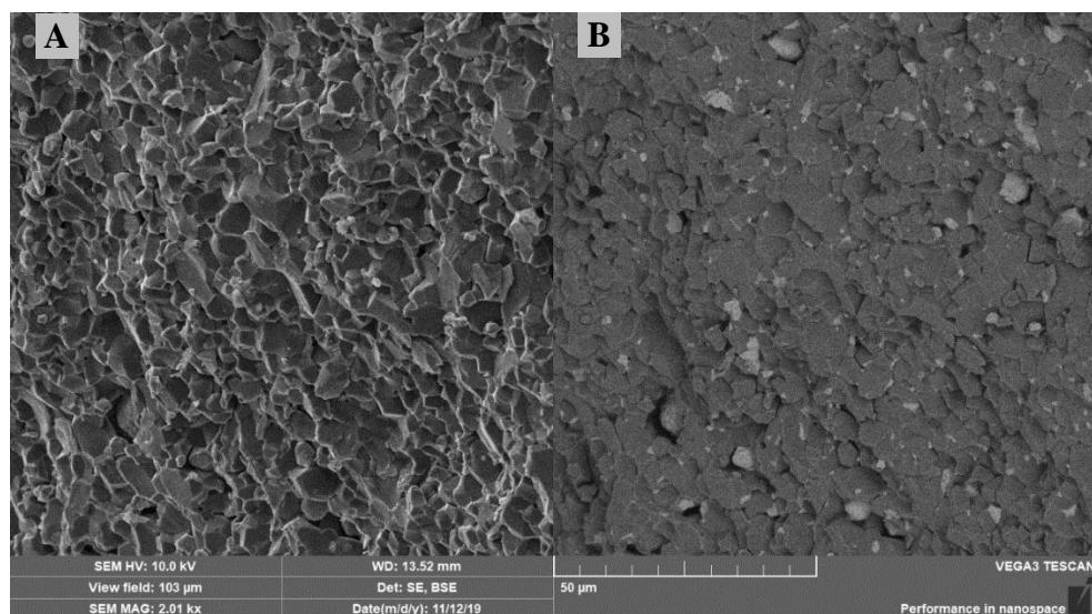
**Slika 32. SEM snimke prijelomne površine sinteriranih uzoraka kompozitne  $\text{Al}_2\text{O}_3$ – $\text{ZrO}_2$  keramike (uzorak s 95%  $\text{Al}_2\text{O}_3$  + 5%  $\text{ZrO}_2$ ) dobivene (A) detektorom sekundarnih elektrona ili SE (eng. Secondary Electron), (B) detektorom povratnog raspršenja ili BSE (eng. Back Scatter Electron)**
