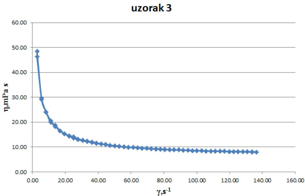
**Slika 23.** Rezultati reoloških mjerena na realnim uzorcima suspenzija: ovisnost prividne viskoznosti o brzini smicanja za 95%Al<sub>2</sub>O<sub>3</sub> + 5%ZrO<sub>2</sub> (uzorak 3)
