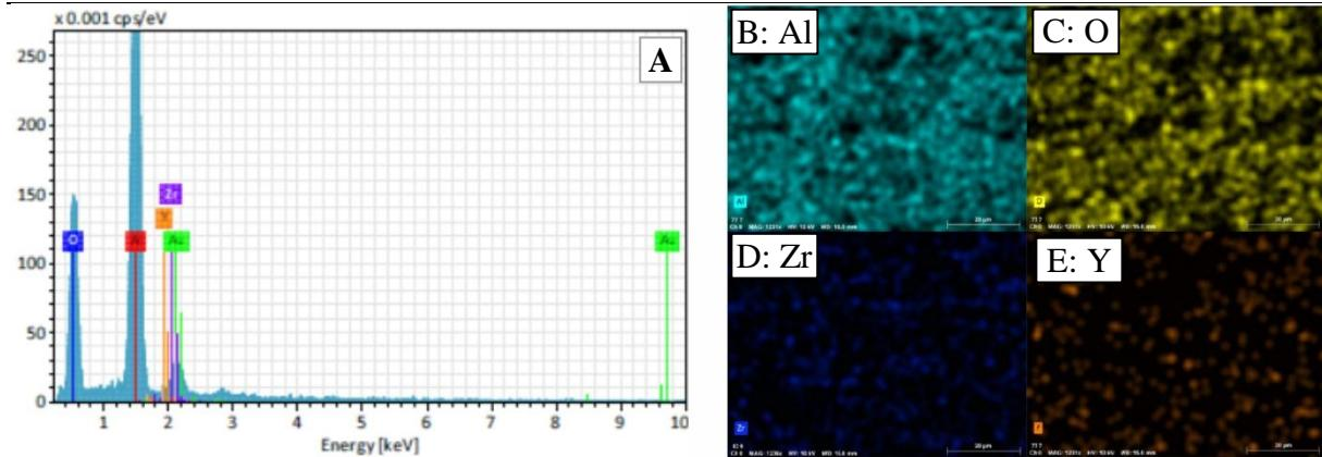
**Slika 31. EDS mapiranje prijelomne površine sinteriranih uzoraka kompozitne  $\text{Al}_2\text{O}_3$ – $\text{ZrO}_2$  keramike (uzorak s 99%  $\text{Al}_2\text{O}_3$  + 1%  $\text{ZrO}_2$ ); (A) EDS spektar; raspodjela kemijskih elemenata: (B) aluminij; (C) kisik; (D) cirkonij; (E) itrij**
