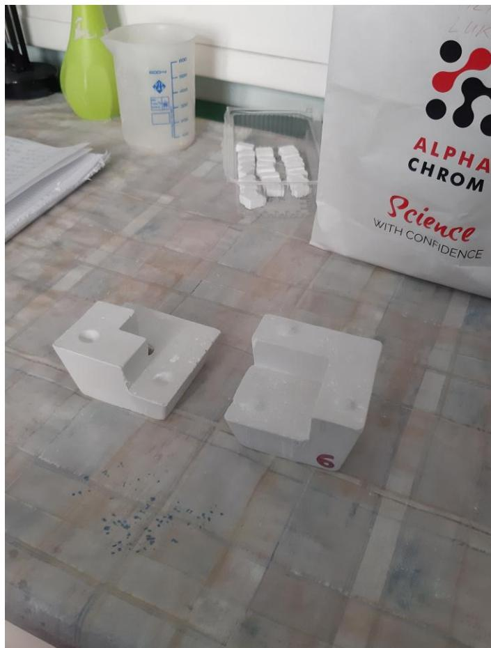
**Slika 15. Rastavljeni gipsani kalup korišten za pripravu sirovca**
