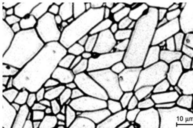
**Slika 5. Snimka mikrostrukture aluminijeva oksida (99,7%) [4]**
