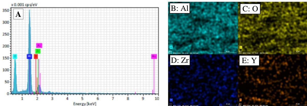
Slika 33. EDS mapiranje prijelomne površine sinteriranih uzoraka kompozitne  $\text{Al}_2\text{O}_3$ – $\text{ZrO}_2$  keramike (uzorak s 95%  $\text{Al}_2\text{O}_3$  + 5%  $\text{ZrO}_2$ ); (A) EDS spektar; raspodjela kemijskih elemenata: (B) aluminij; (C) kisik; (D) cirkonij; (E) itrij
