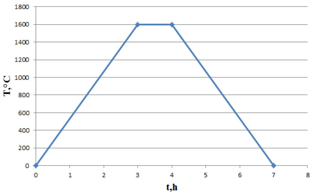
Slika 18. Dijagram postupka za primjenjeni režim sinteriranja
