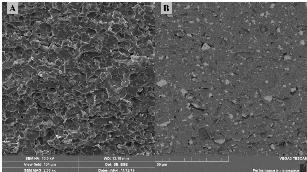
Slika 34. SEM snimke prijelomne površine sinteriranih uzoraka kompozitne  $\text{Al}_2\text{O}_3$ – $\text{ZrO}_2$  keramike (uzorak s 90%  $\text{Al}_2\text{O}_3$  + 10%  $\text{ZrO}_2$ ) dobivene (A) detektorom sekundarnih elektrona ili SE (eng. Secondary Electron), (B) detektorom povratnog raspršenja ili BSE (eng. Back Scatter Electron)
