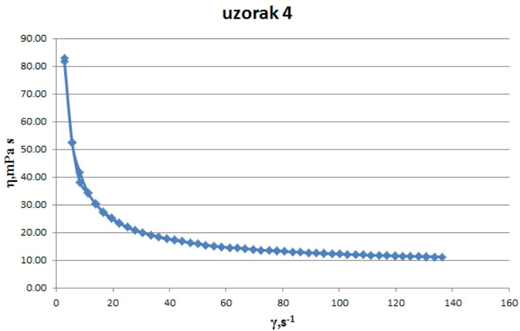
**Slika 24.** Rezultati reoloških mjerena na realnim uzorcima suspenzija: ovisnost prividne viskoznosti o brzini smicanja za 90%Al<sub>2</sub>O<sub>3</sub> + 10%ZrO<sub>2</sub> (uzorak 4)
