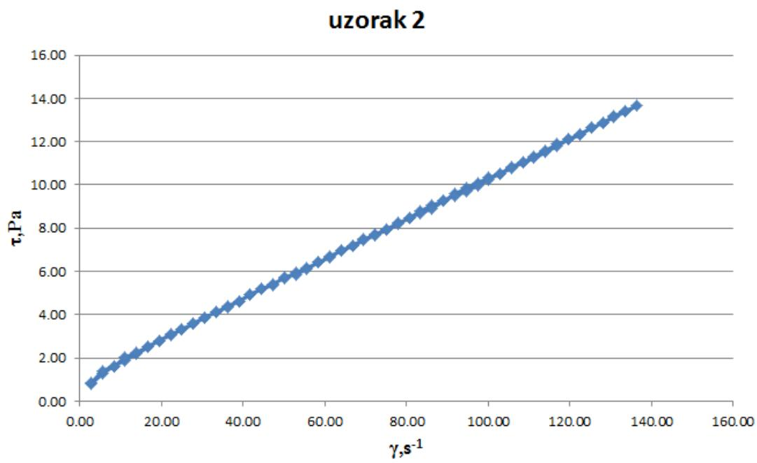
**Slika 26.** Rezultati reoloških mjerena na realnim uzorcima suspenzija: ovisnost sмиčnog naprezanja o brzini smicanja za 99%Al<sub>2</sub>O<sub>3</sub> + 1%ZrO<sub>2</sub> (uzorak 2)
