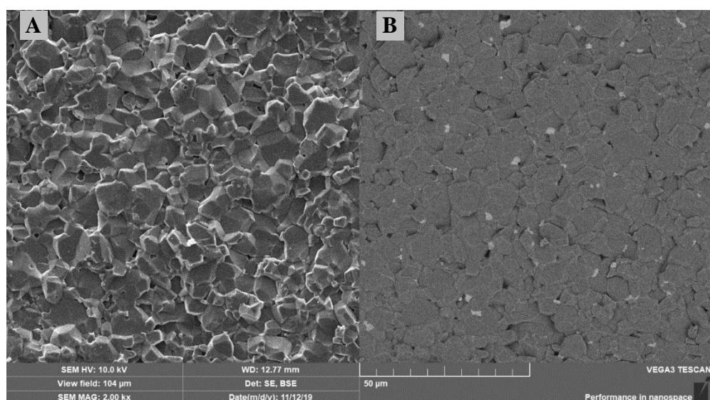
**Slika 30.** SEM snimke prijelomne površine sinteriranih uzoraka kompozitne  $\text{Al}_2\text{O}_3$ – $\text{ZrO}_2$  keramike (uzorak s 99%  $\text{Al}_2\text{O}_3$  + 1%  $\text{ZrO}_2$ ) dobivene (A) detektorom sekundarnih elektrona ili SE (eng. Secondary Electron), (B) detektorom povratnog raspršenja ili BSE (eng. Back Scatter Electron)
