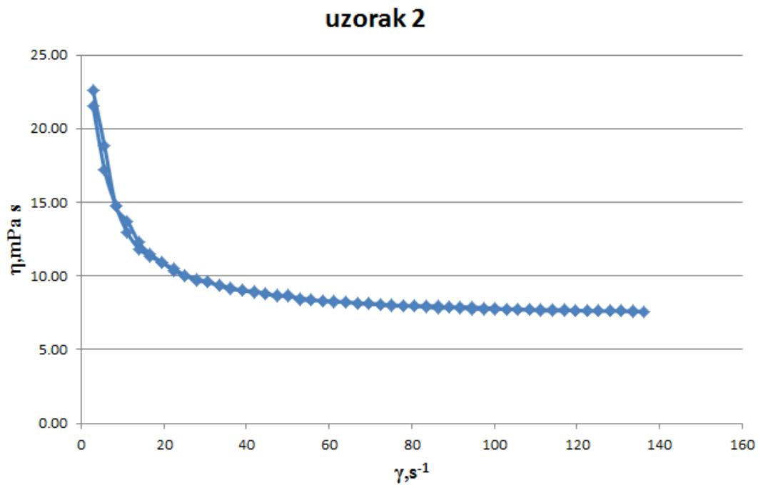
**Slika 22.** Rezultati reoloških mjerena na realnim uzorcima suspenzija: ovisnost prividne viskoznosti o brzini smicanja za 99%Al<sub>2</sub>O<sub>3</sub> + 1%ZrO<sub>2</sub> (uzorak 2)
