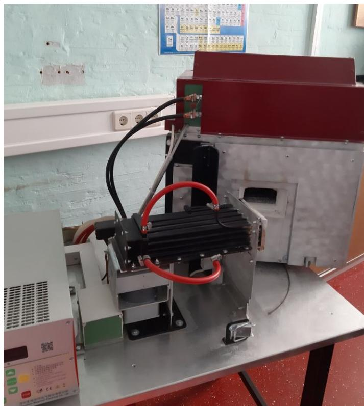
Slika 17. Mikrovalna peć za sinteriranje Wepex 4000B
