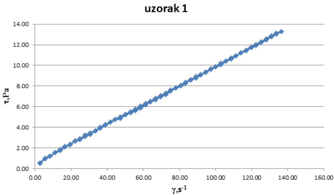
**Slika 25.** Rezultati reoloških mjerena na realnim uzorcima suspenzija: ovisnost smičnog naprezanja o brzini smicanja za 100%Al<sub>2</sub>O<sub>3</sub> (uzorak 1)
