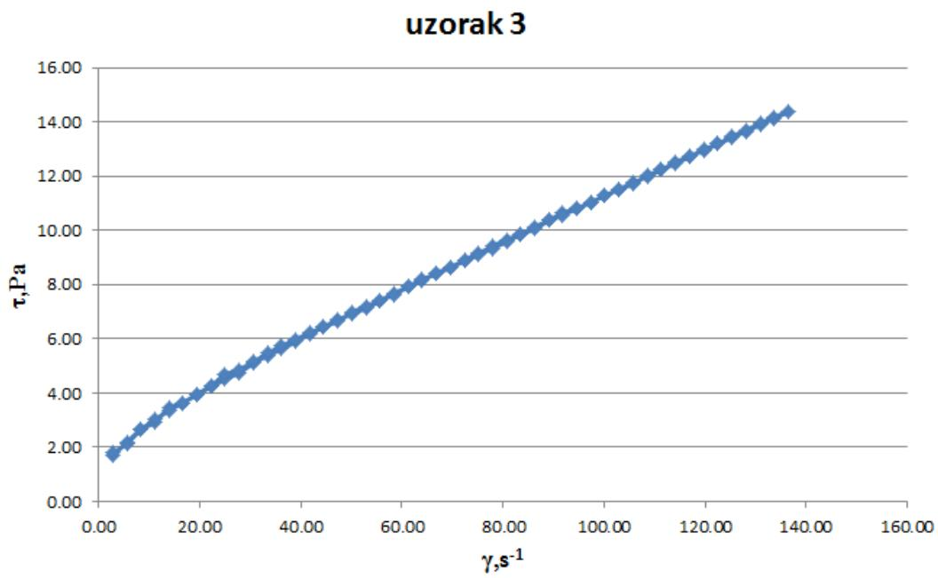
**Slika 27.** Rezultati reoloških mjerena na realnim uzorcima suspenzija: ovisnost sмиčnog naprezanja o brzini smicanja za 95%Al<sub>2</sub>O<sub>3</sub> + 5%ZrO<sub>2</sub> (uzorak 3)
