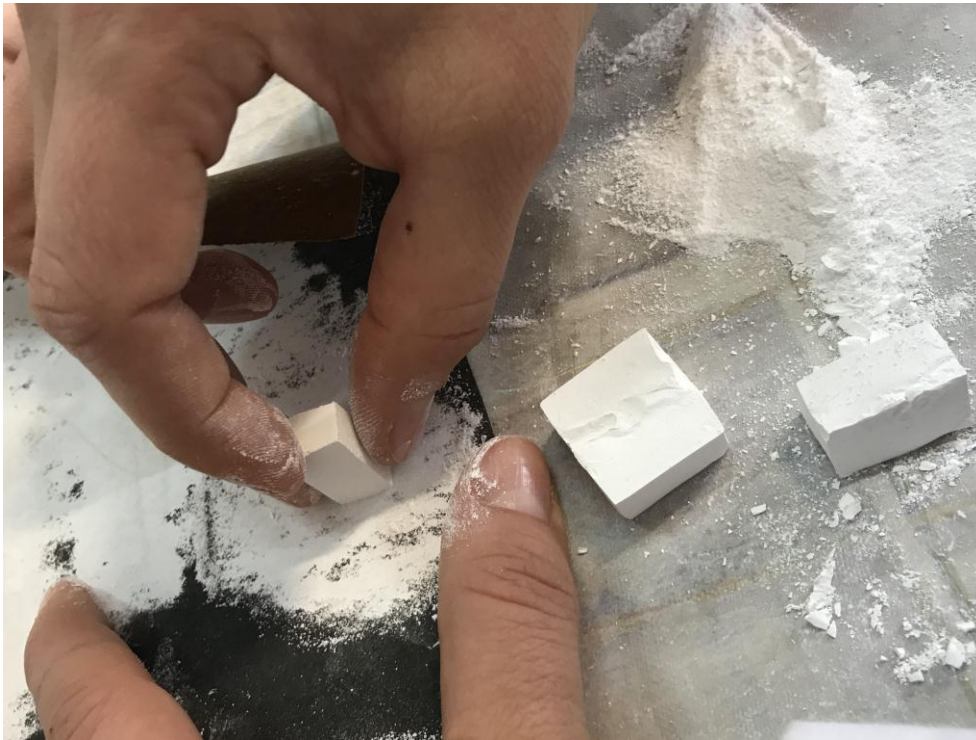
Slika 16. Brušenje sirovaca (zelena obrada)
