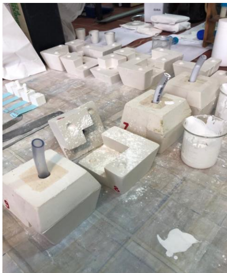
Slika 12. Gipsani kalupi za lijevanje suspenzija
