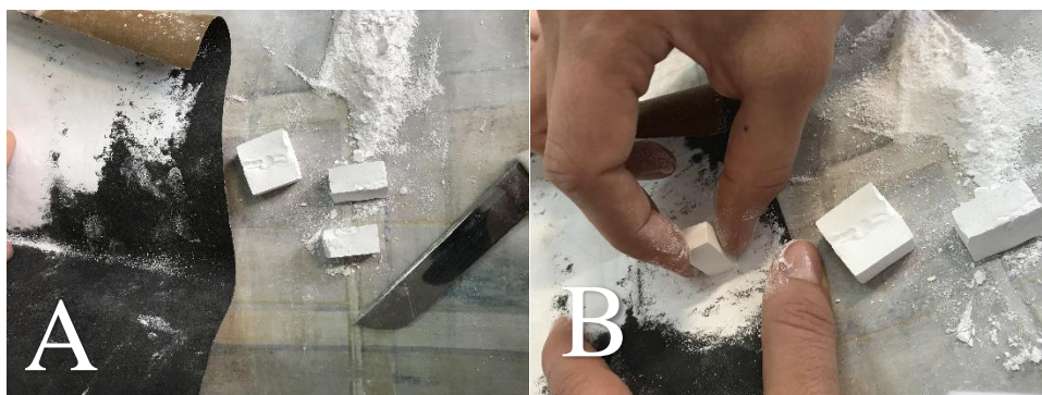
Slika 13. Oblikovanje uzoraka nožem(A); brusnim papirom(B)
