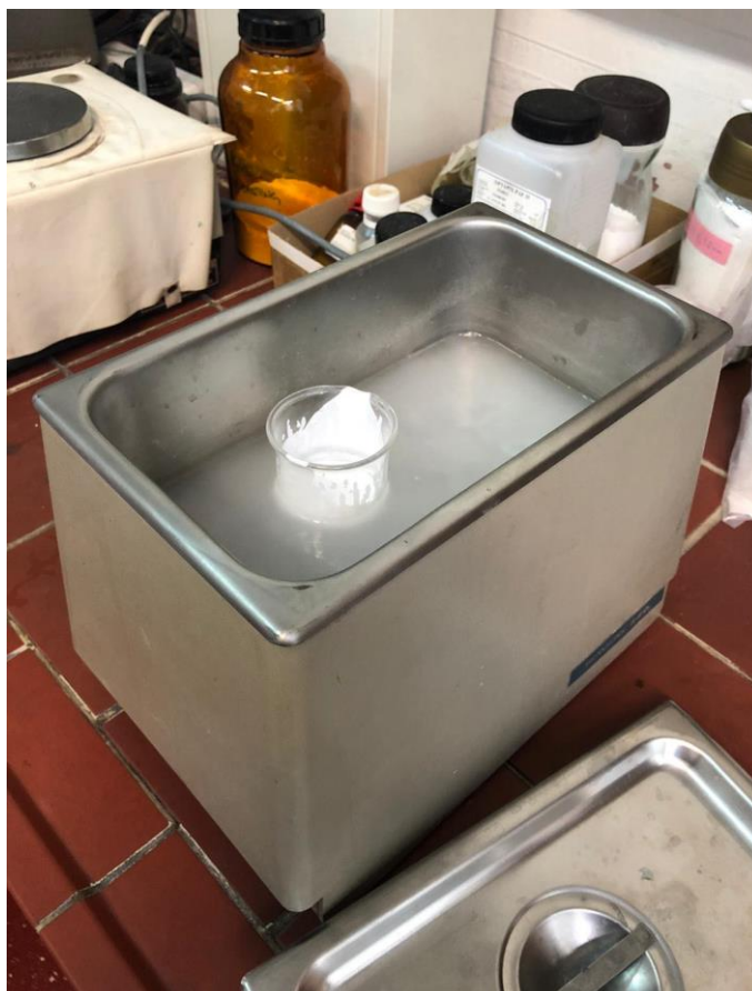
Slika 10. Tretiranje suspenzije u ultrazvučnoj kupelji
