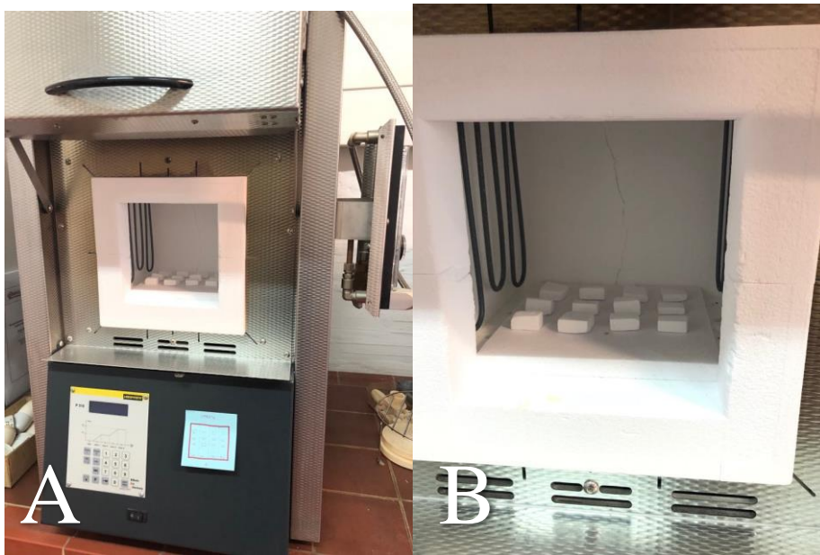
Slika 14. Nabertherm P310 peć za sinteriranje(A); raspored uzoraka unutar peći(B)
