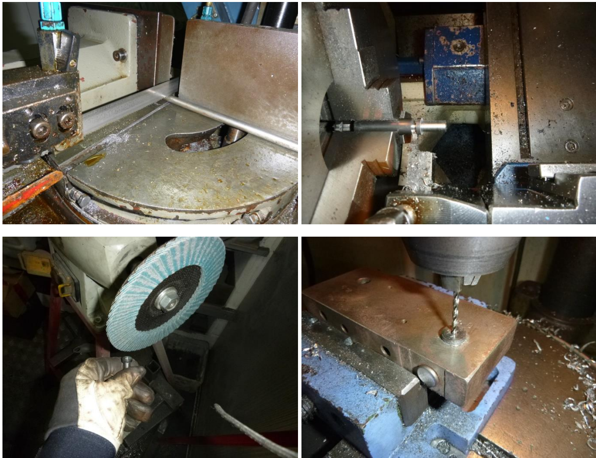
Slika 4. Prikaz postojećeg načina izrade svornjaka
