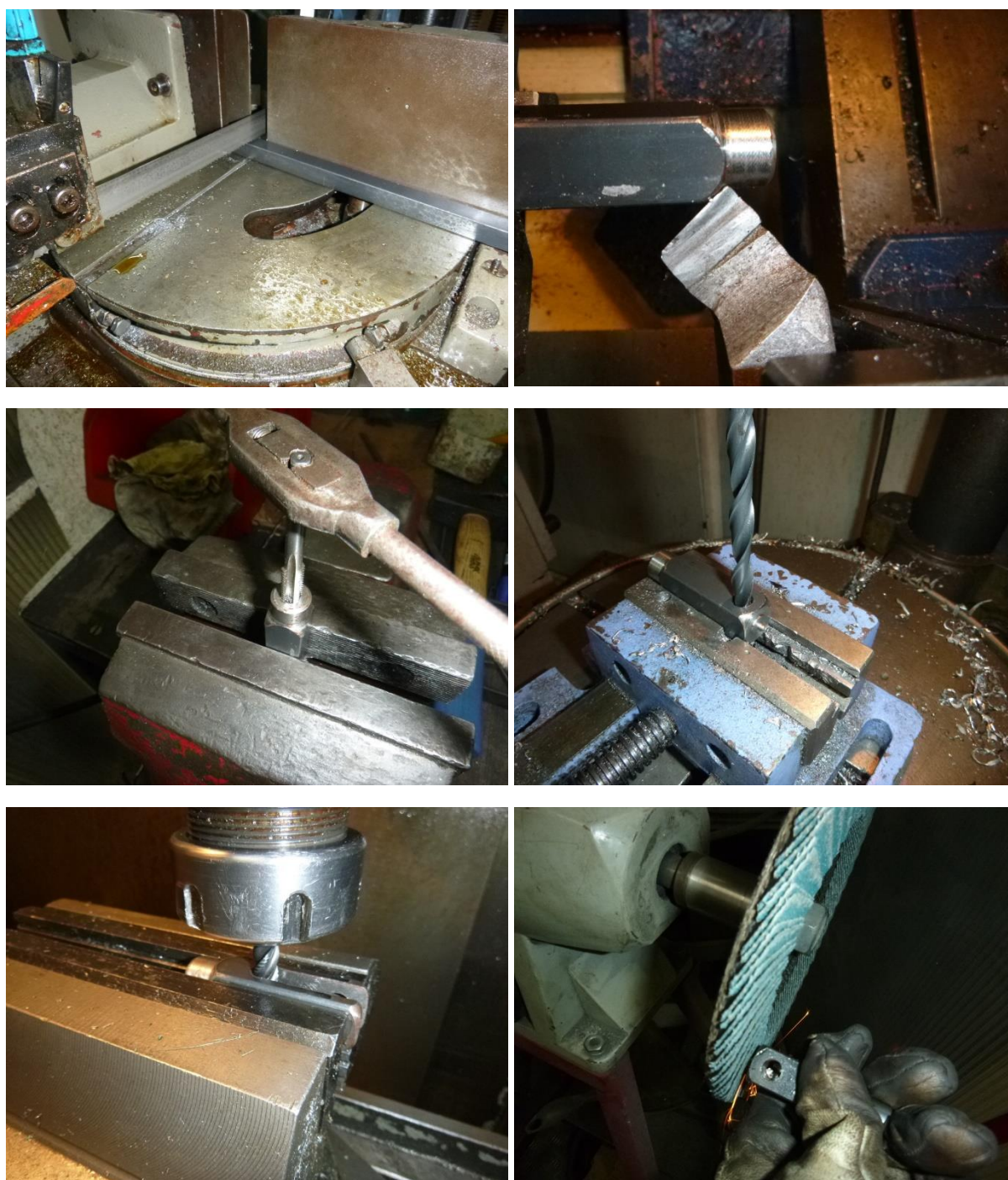
Slika 3. Prikaz postojećeg načina izrade vilice
