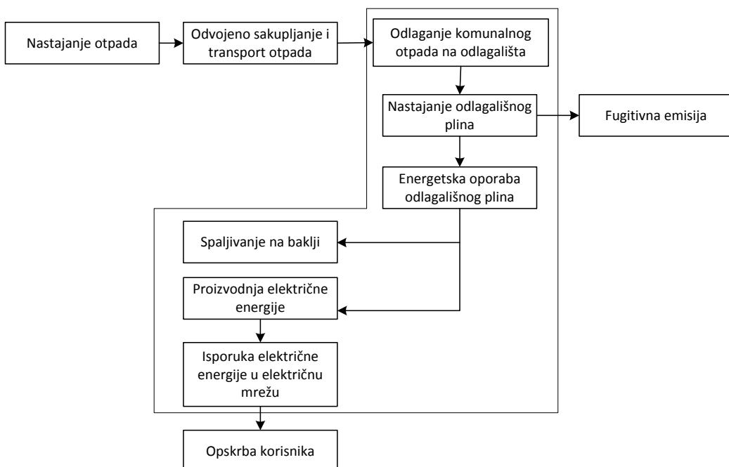
Slika 4. Postupak proizvodnje električne energije iz odlagališnog plina [10]
