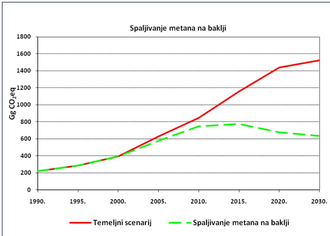
Slika 12. Emisije CH<sub>4</sub> uz mjeru spaljivanja metana na baklji
