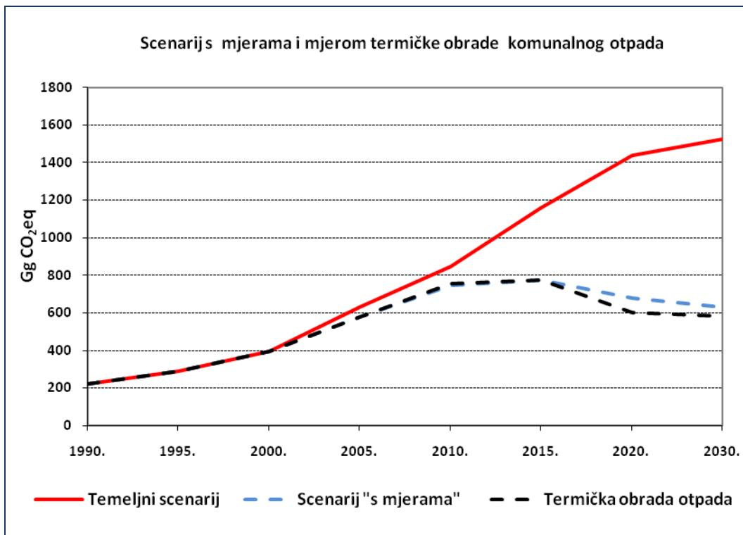
Slika 13. Emisije CH<sub>4</sub> uz mjeru termičke obrade komunalnog otpada
