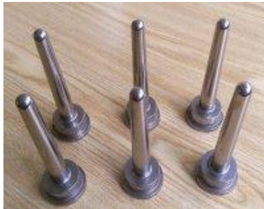
Slika 4.10. Primjer TiBN prevlake [18]
