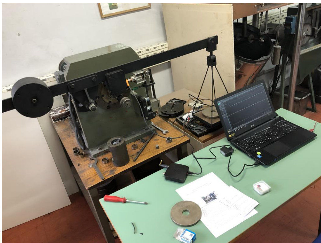
Slika 5.5. Ispitna metoda prizma po prstenu uz primjenu računala
