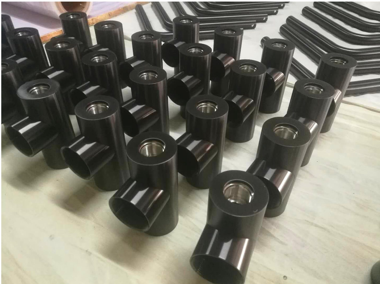
Slika 4.11. Primjer DLC prevlake [21].
