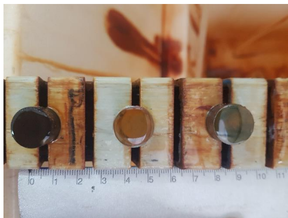
Slika 25. Uzorci u slanoj komori nakon 4h s lijeva na desno 2-5-8
