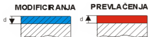
Slika 1. Razlika između modificiranja i prevlačenja [3]
