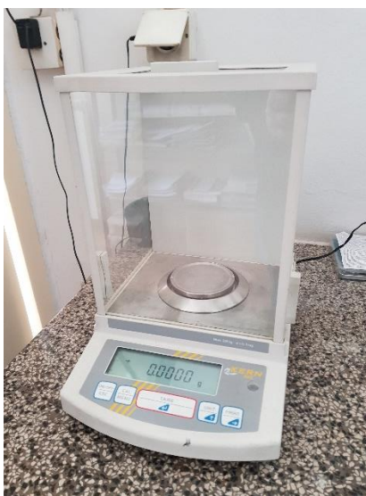
Slika 19. Analitička vaga sa mogućnosti vaganja na četvrtu decimalu
