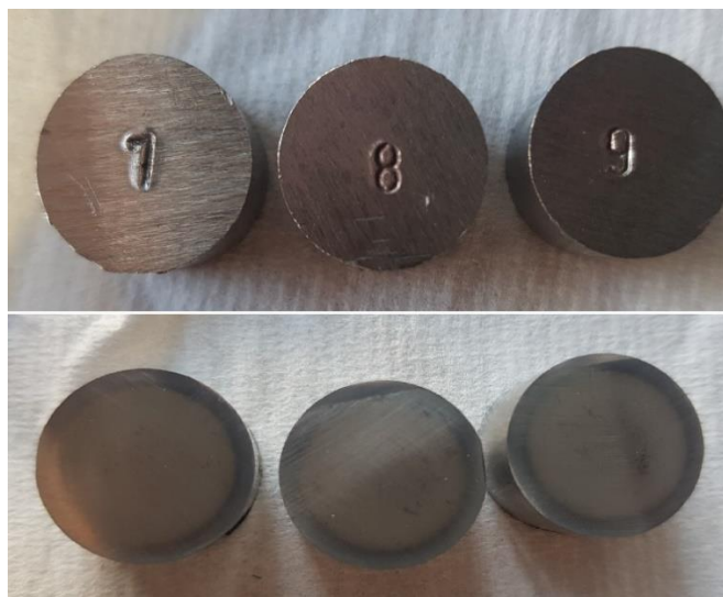
Slika 15. Uzorci nakon nitriranja u plazmi
