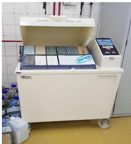
Slika 21. Vlažna komora (eng. *Humidity chamber*)
