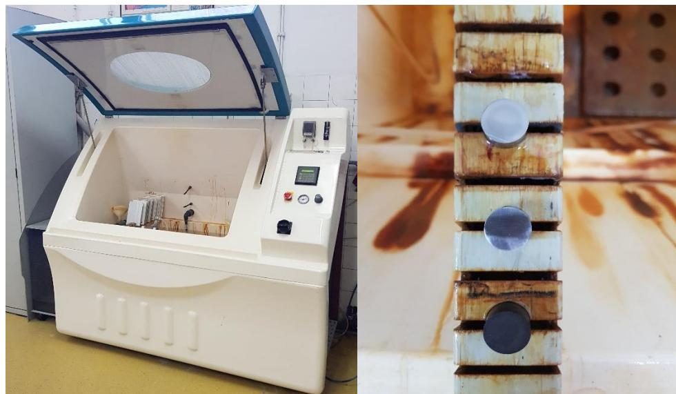
**Slika 24. Ispitivanje uzorka u slanoj komori**
