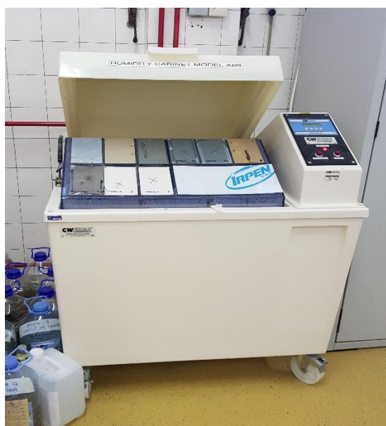
Slika 21. Vlažna komora (eng. Humidity chamber )
