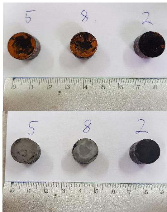
Slika 26. Uzorci nakon 24h u slanoj komori prije (gore) i poslije (dolje) pranja i sušenja
