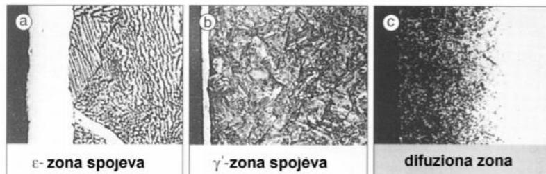
**Slika 5. Mikrostruktura zone spojeva i difuzijske zone [6]**
