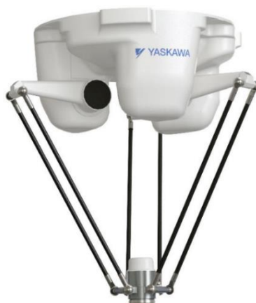
Slika 5. Delta robot YASKAWA MPP3S
