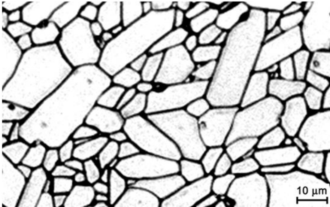
Slika 5. Mikrostruktura aluminij-oksidge keramike (99,7%) [1]
