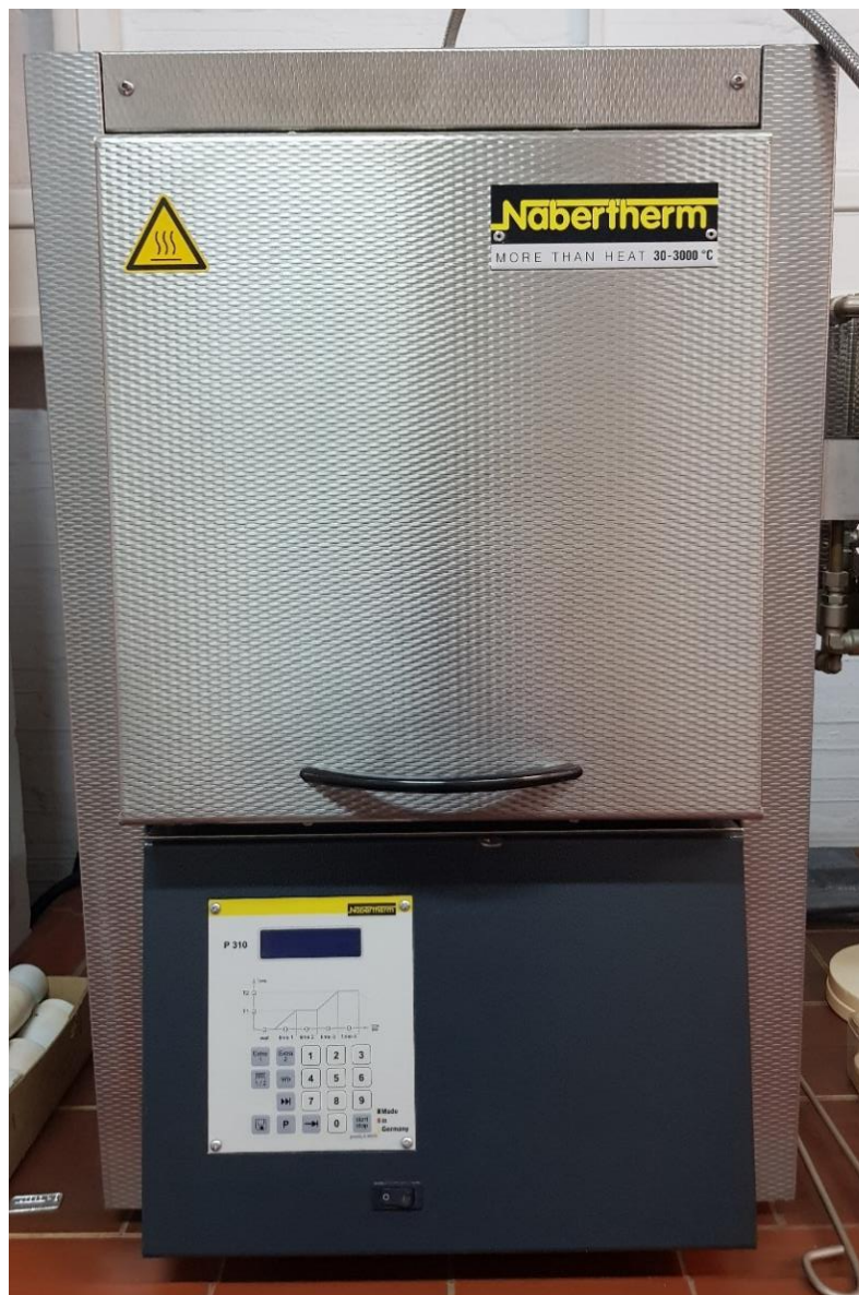
Slika 16. Nabertherm - peć za sinteriranje
