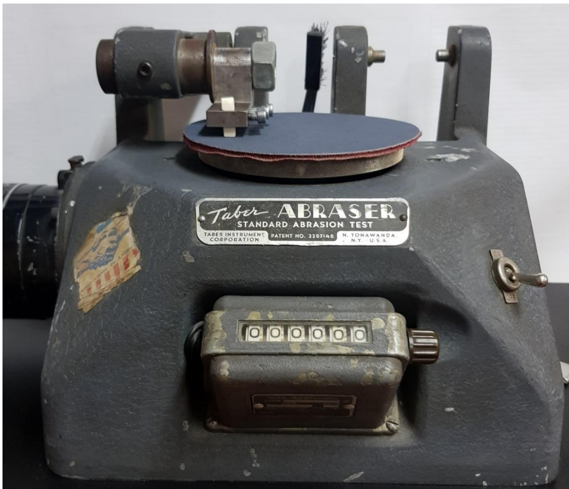
Slika 25. Uređaj za ispitivanje otpornosti na trošenje
