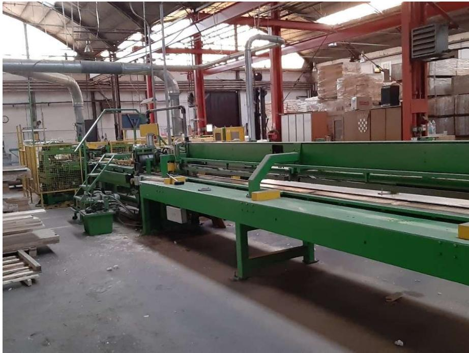
**Slika 6-8 Stroj za izradu dužinskih lamela s cink-spojem**
