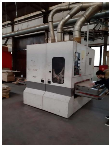
**Slika 6-12 Stroj za dvostrano blanjanje ploča**
