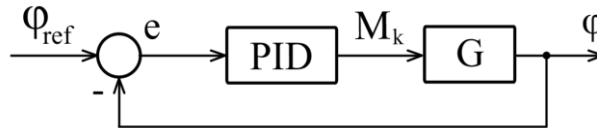
Slika 13. Blok shema PID regulatora
