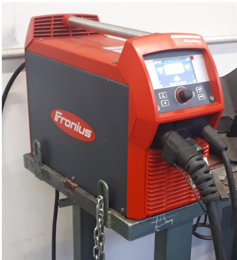
**Slika 18. Uredaj za TIG zavarivanje Fronius tipa MagicWave 230i EF**
