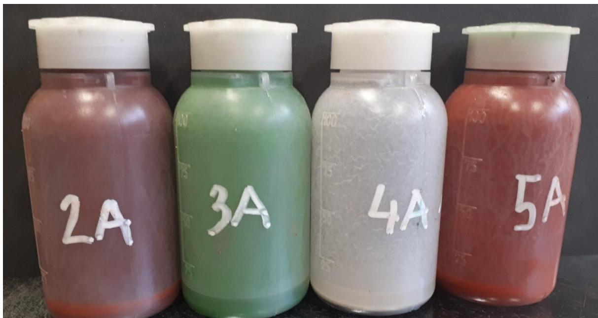
Slika 17. Pripremljeni aktivacijski –TIG premazi
