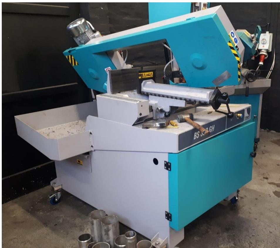
**Slika 14. Rezanje uzoraka na tračnoj pili**
