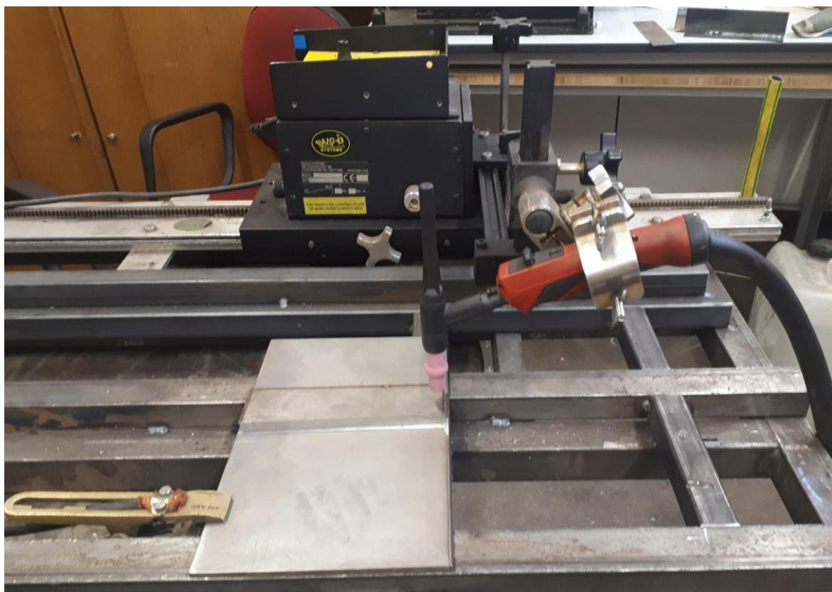
Slika 19. „Bugo Systems“, uređaj za automatiziranje postupka zavarivanja
