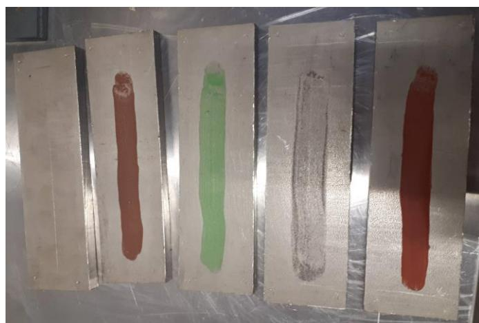
**Slika 21. Pripremljeni uzorci s nanešenim aktivacijskim premazima**
